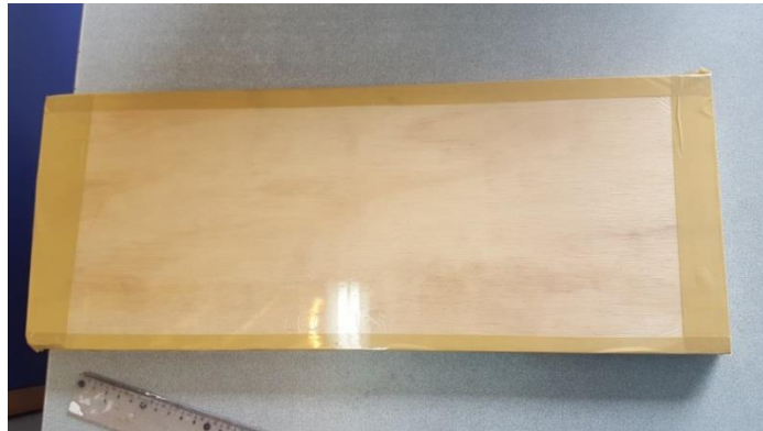
Figura 4 Soporte para elaboración de probetas de fibra de carbono
