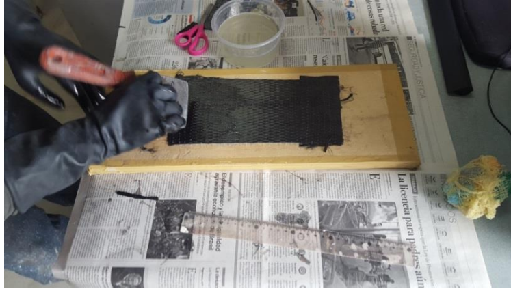
Figura 7 Colocación de resina sobre fibra
