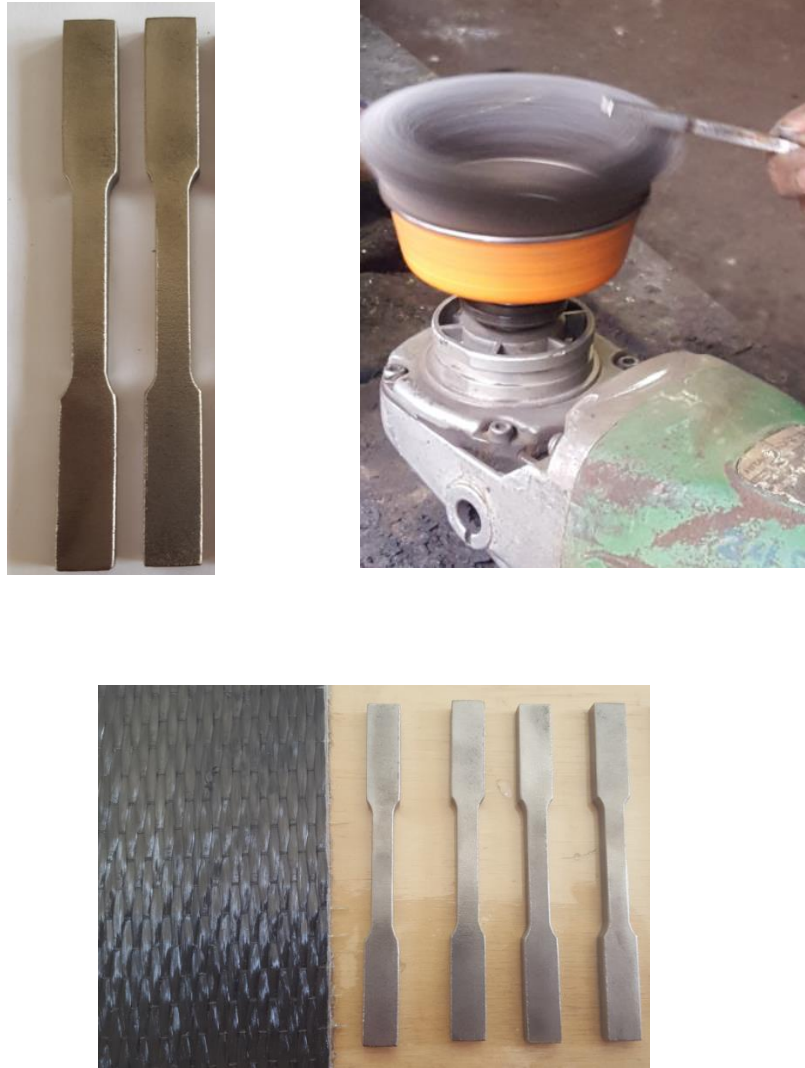
Figura 11 Preparación de la superficie de acero para adherir la fibra de carbono
