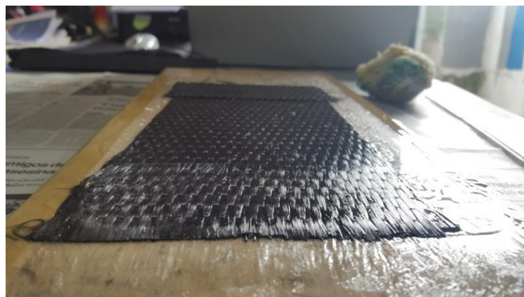
Figura 9 Conformación del material para elaborar la probeta
