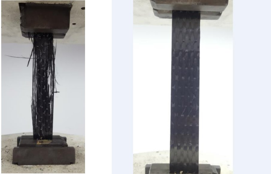
Figura 14 Ensayos de tracción y estado final de las probetas
