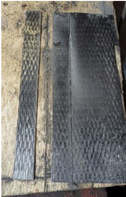
Figura 10 Corte de probetas de fibra de carbono
