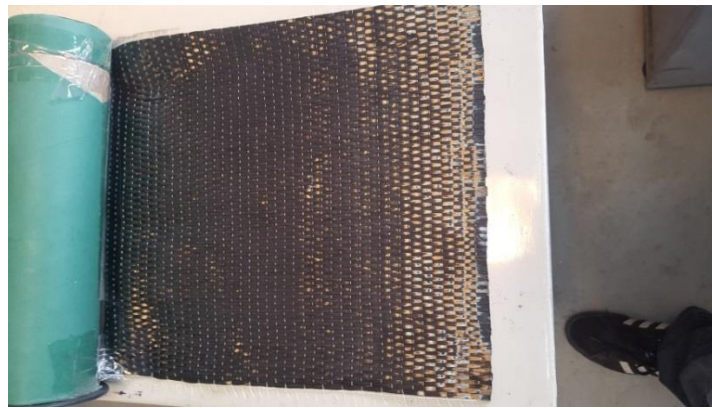
Figura 5 Lámina o tejido carbowrap 600 de fibra de carbono
