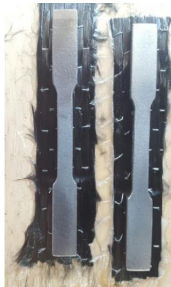
Figura 12 Colocación de fibra de carbono sobre el metal
