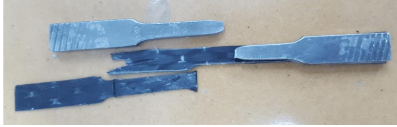
Figura 15 Ensayos de tracción y estado final de las probetas
