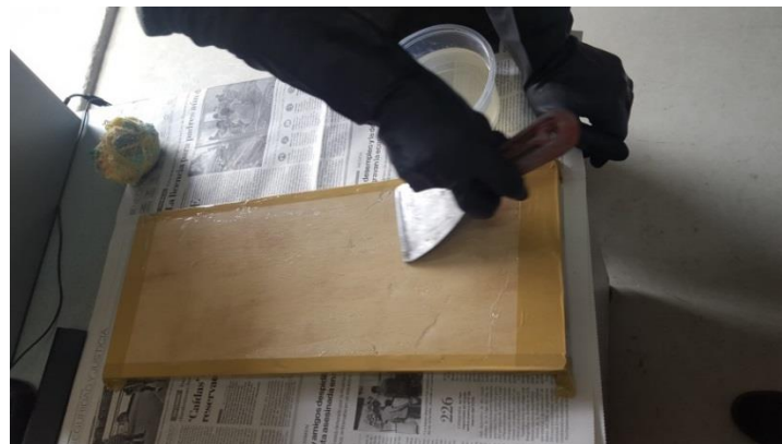
Figura 6 Colocación de resina o matriz
