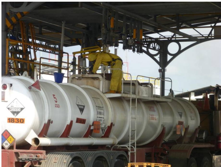
Figura No. 23 Apertura o cierre de manhole de tanquero Fuente: Elaboración Propia
