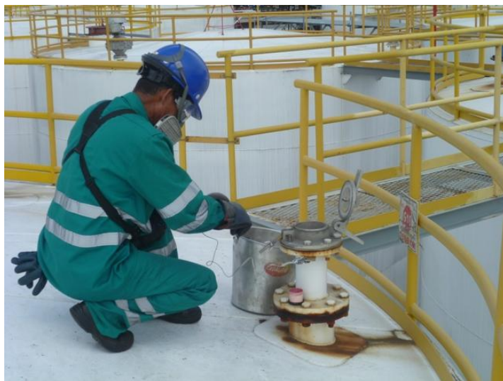
Figura No. 22 Medición de tanques – altura de producto y temperatura Fuente: Elaboración Propia
