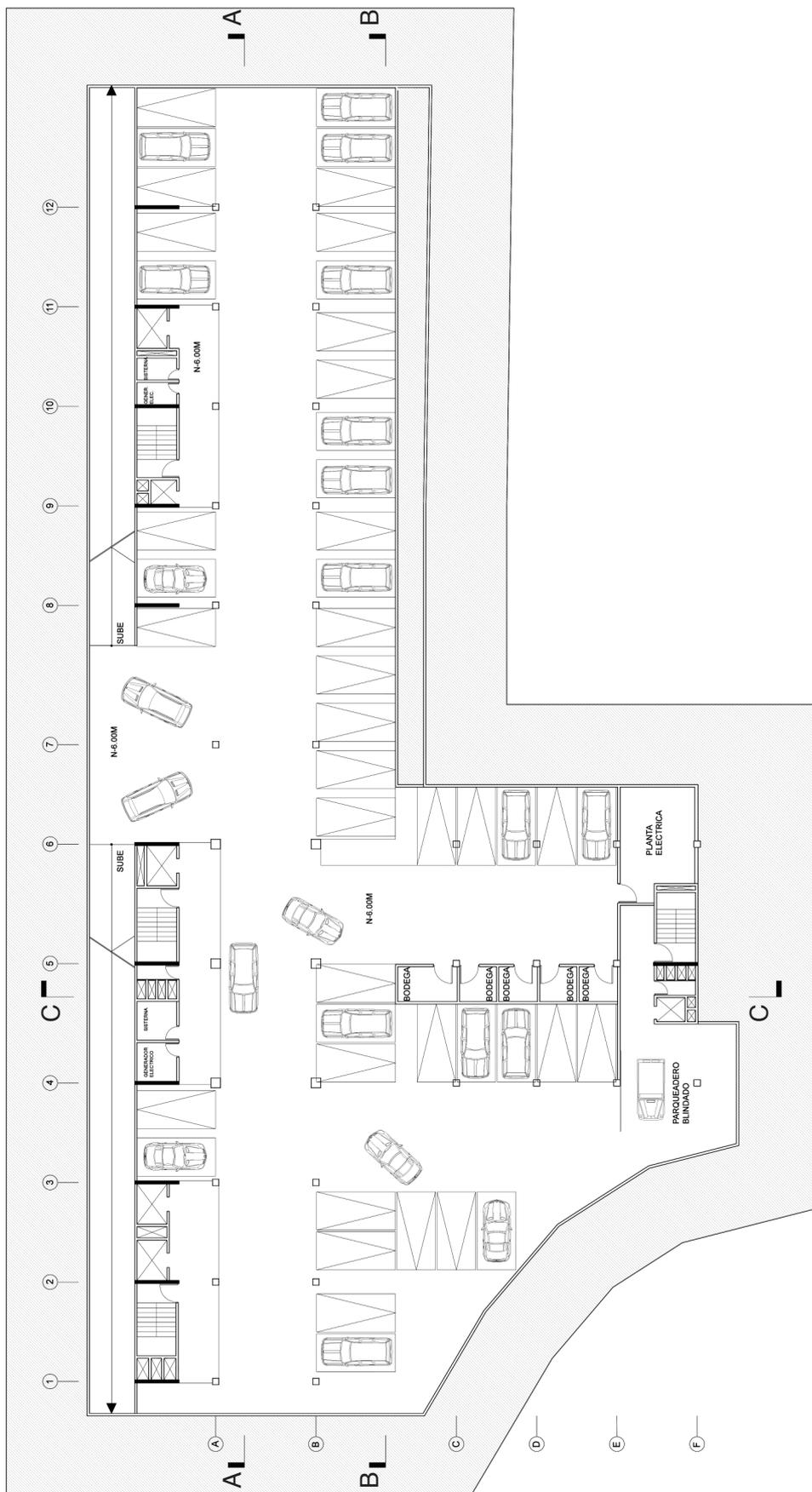
Figura # 7.1: Planta Nivel -6.0m ESC. 1:400 (Elaboración Propia)
