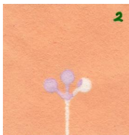
Fotografía1. Ensayo detección de proteínas: Carga realizada directamente en los pocillos derecho y centro cargados con 3\mu L de reactivo ( 100\mu M ), pocillo izquierdo vacío (control).
