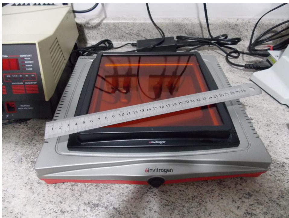
Fotografía11. Transiluminador de luz azul (LEDs) marca Invitrogen, transiluminador Safe Imager 2.0 de luz azul
