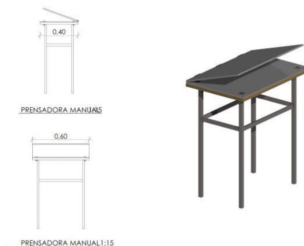
Gráfico No. 21 Diseño escogido para la prensa manual de botellas plásticas.
