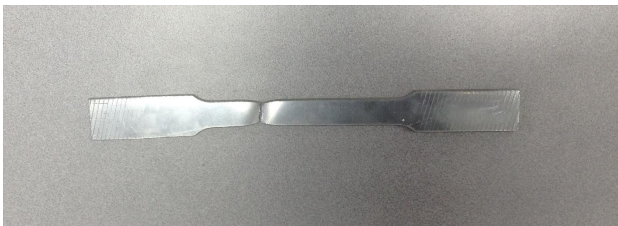
Imagen 22. Probeta de aluminio ensayada hasta la ruptura.
