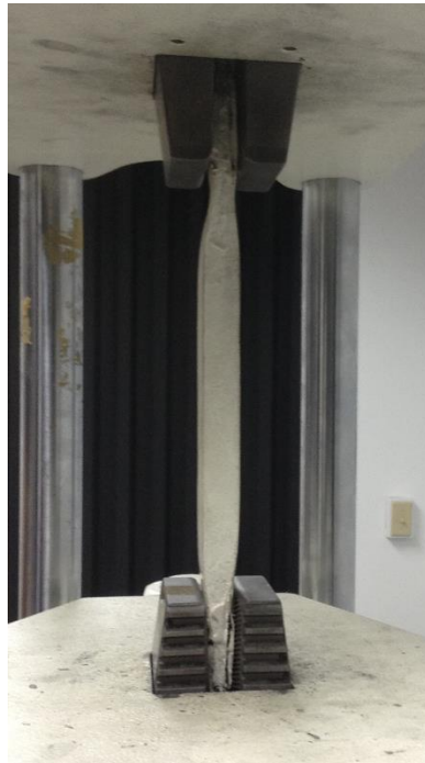
Imagen 28. Ensayo de Tracción en probeta de material compuesto, vista lateral.
