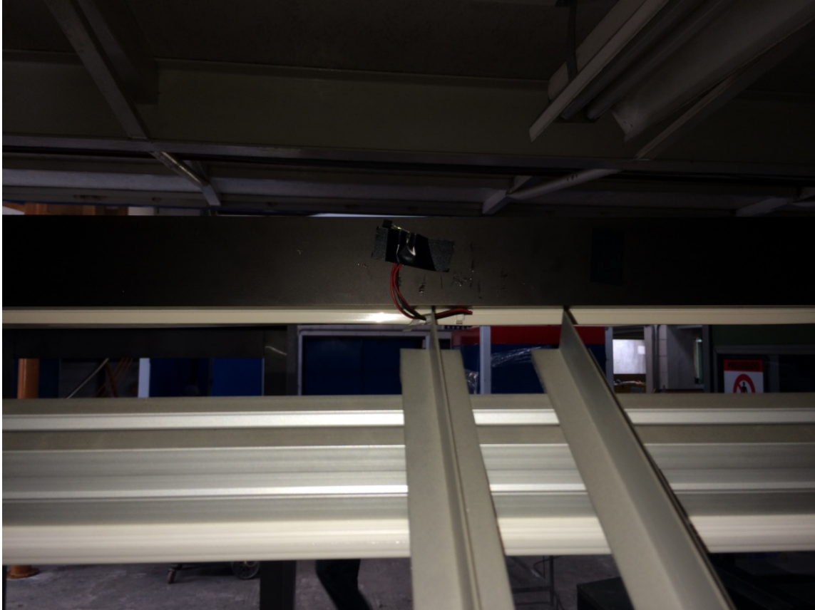
Figura 25. Ubicación del sensor de temperatura. Se encuentra en la parte superior trasera de la máquina. En esta imagen el sensor LM35 no está colocado.
