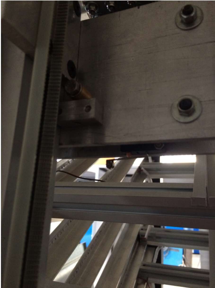
Figura 21. Fin de carrera para el movimiento vertical. Este fin de carrera está ubicado en el brazo mecánico.
