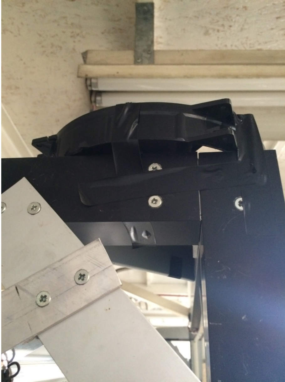
Figura 26. Ubicación del ventilador en el prototipo. Se encuentra en la esquina superior derecha en la parte de atrás de la máquina. Para la versión final se planea colocarlo en la parte superior central.
