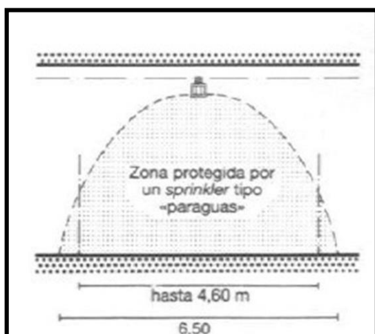
Sprinklers tipo paraguas.
