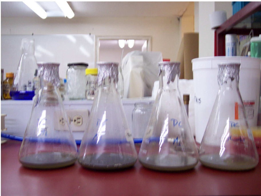
Figura 2. Erlenmeyers con 90ml de caldo LB y 10g de la muestra de lodo, el tamaño grande del erlemeyer es para asegurar un buen intercambio gaseoso.
