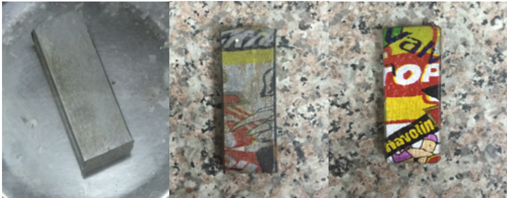
Figura 21: probetas luego del ensayo de corrosión (acero, recubrimiento de la película, brillo y endurecedor).
