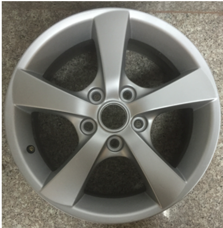
Figura 3: aro con superficie pulida y puesto color plata como base
