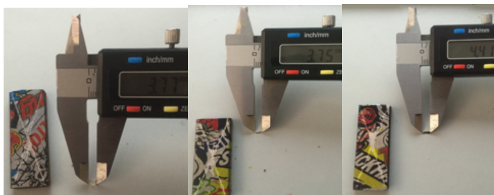
Figura 24: probetas acero con recubrimiento de brillo y endurecedor
