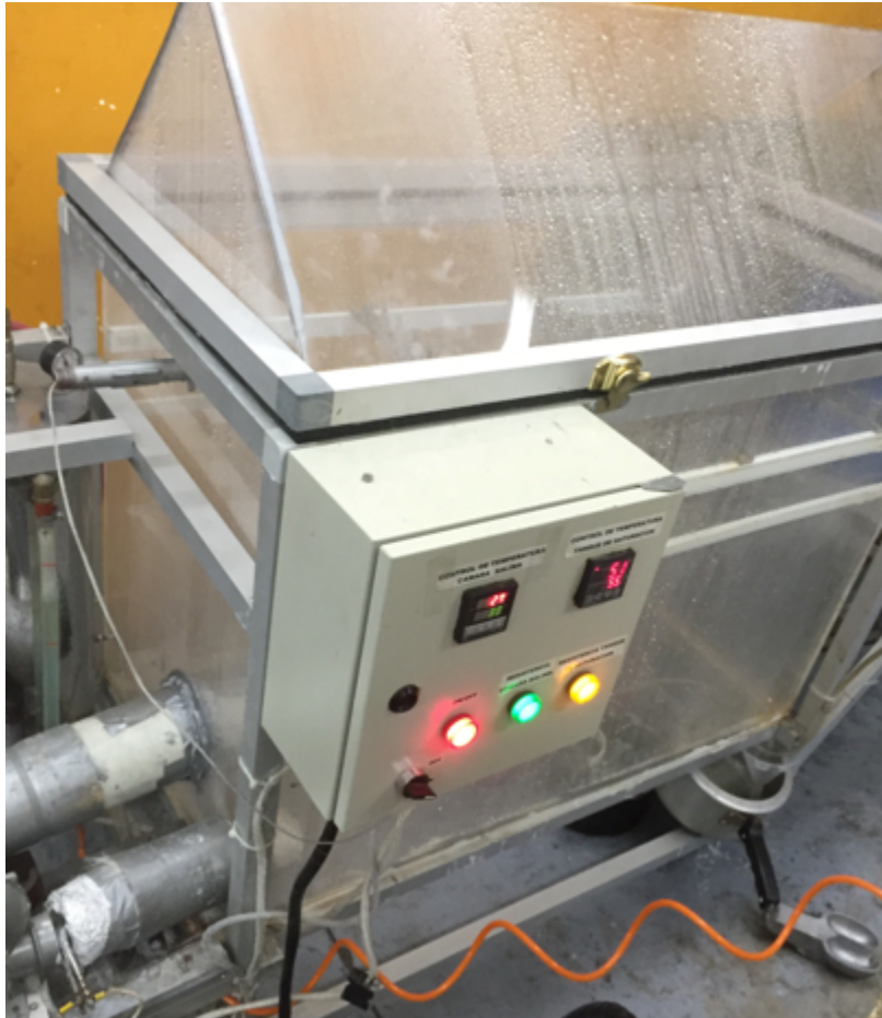
Figura 13: cámara salina según norma ASTM B117 - 03
