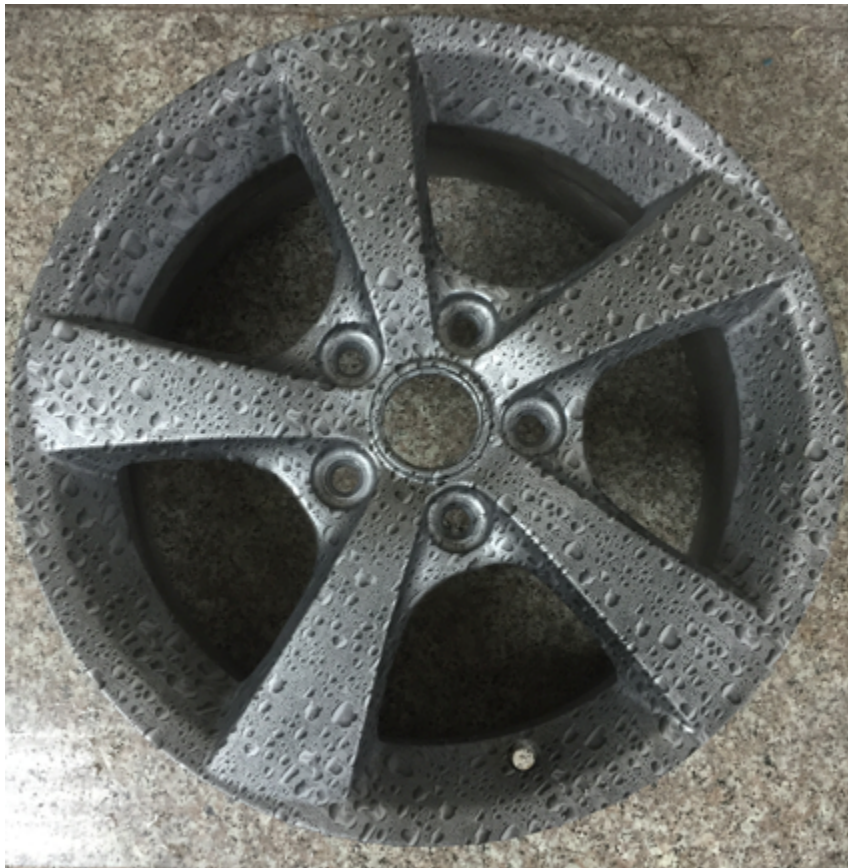
Figura 10: Diseño impreso sobre la superficie del aro
