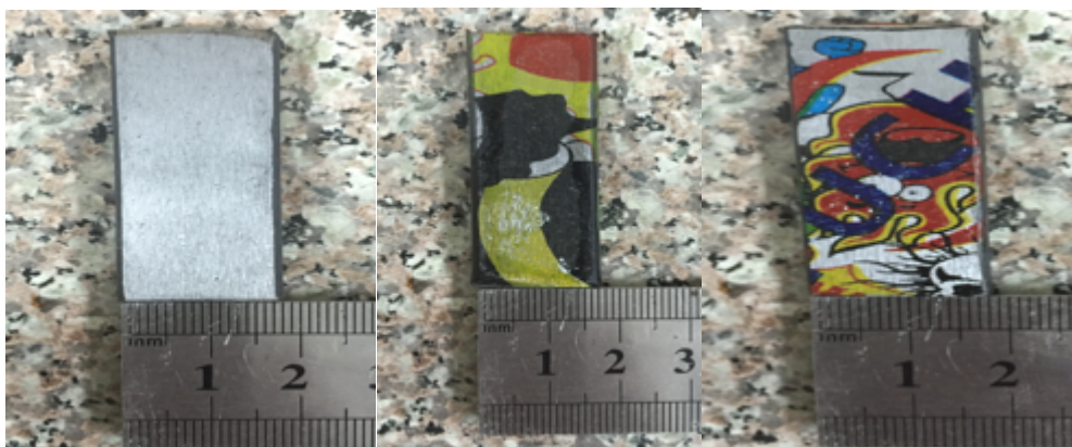
Figura 14: probetas utilizadas para el ensayo de corrosión
