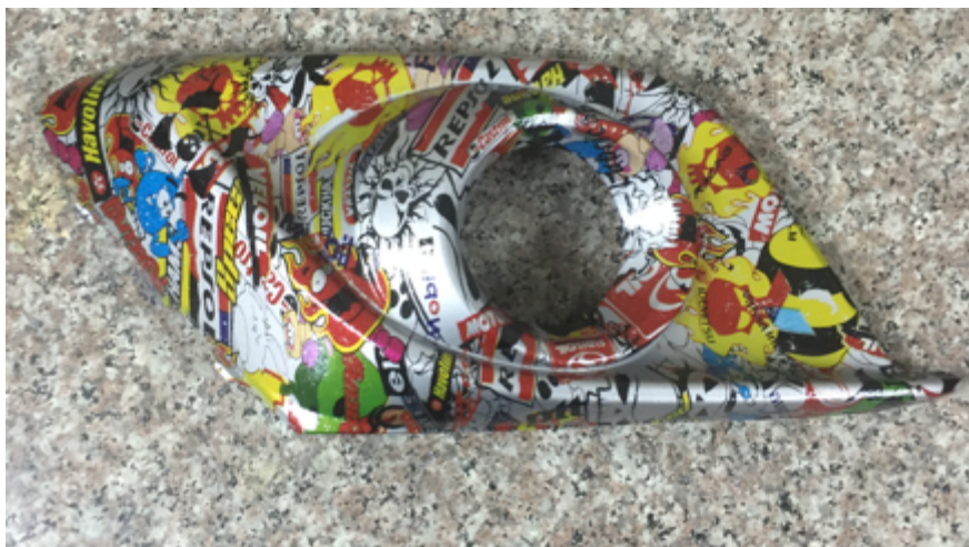
Figura 18: acabado final pieza mediana (porta alógenos Hyundai Accent 2012 lado derecho)
