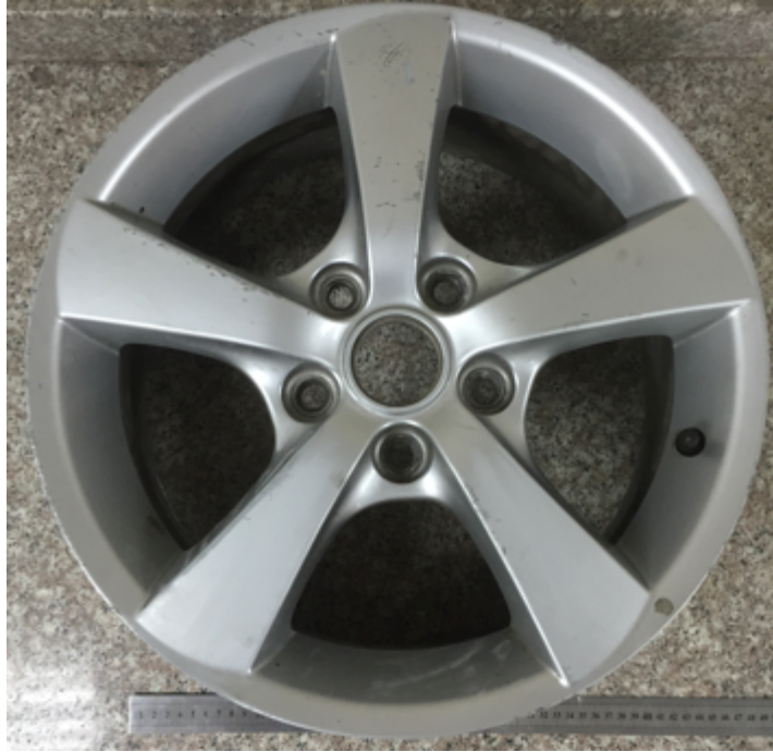
Figura 2: Aro Automóvil ( diámetro = 45 cm , altura = 15 cm)
