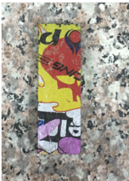
Figura 15: probetas solo con recubrimiento de la película
