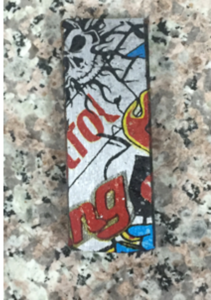
Figura 16: probetas con recubrimiento (brillo y endurecedor)
