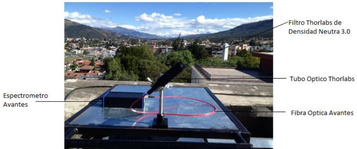
Figura 5. Fotografía realizada en la Estación de Mediciones Atmosféricas (EMA) de la USFQ en Agosto del 2016. La fibra óptica se apoya en un tubo óptico el cual tiene incorporado un filtro de densidad neutra 3.0. La fibra óptica está conectada al espectrómetro el cual a su vez está conectado al software Avasoft donde se visualiza el espectro solar (Figura 6).
