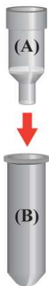
Figura 7: Gráfica de la posición correcta para el ensamblaje de las columnas de precipitación/tubos de recolección en el kit S.N.A.P (Invitrogen, 2002).
