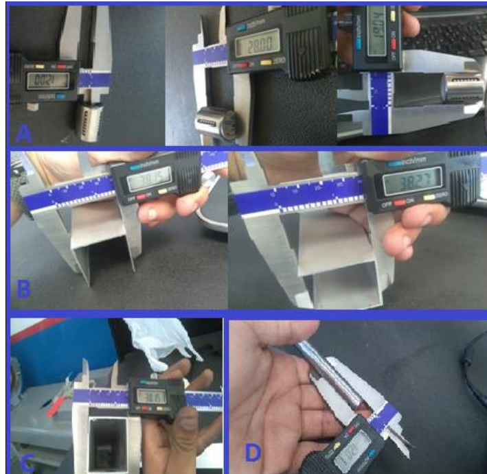
Figura 2.2.- (A) Medición cojinete, (B) Medición Perfil 1386 cortado, (C) Medición Perfil 1386 y (D) Medición Eje Acero 12 mm diámetro
