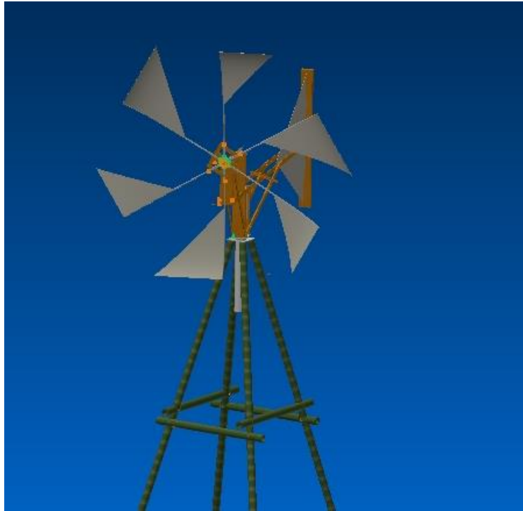
FIGURA 3.77: ROTOR Y ESTRUCTURA MÓVIL INSTALADAS SOBRE LA TORRE
