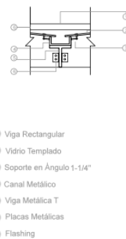
Detalle Cubierta de Vidrio Esc 1:05
