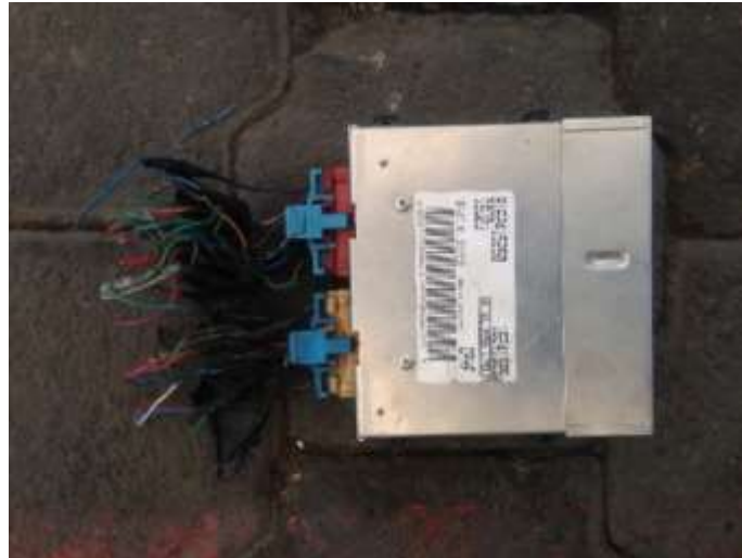
Ilustración 42 Unidad Electrónica de Control (el autor, 2016)
