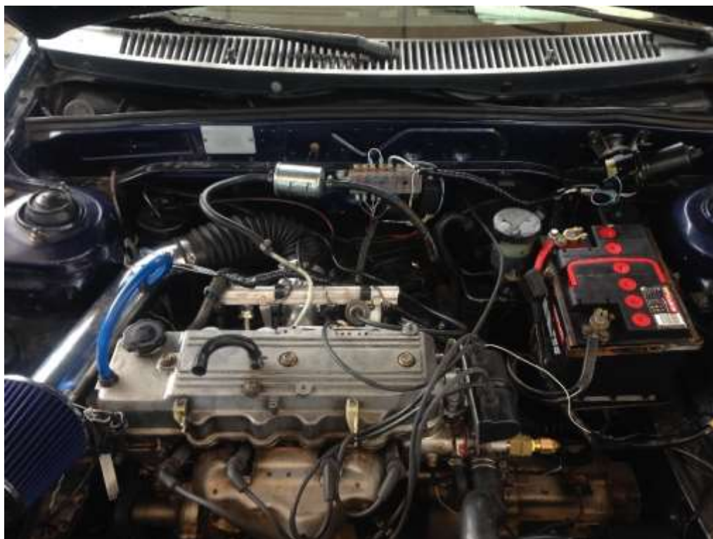
Ilustración 61 Montaje Completo Sistema de Inyección (el autor, 2016)
