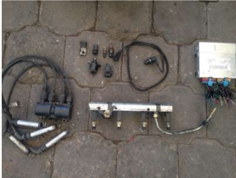
Ilustración 37 Kit de Inyección (el autor, 2016)
