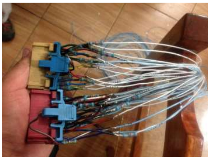
Ilustración 43 Soker Unidad Electrónica de Control (el autor, 2016)
