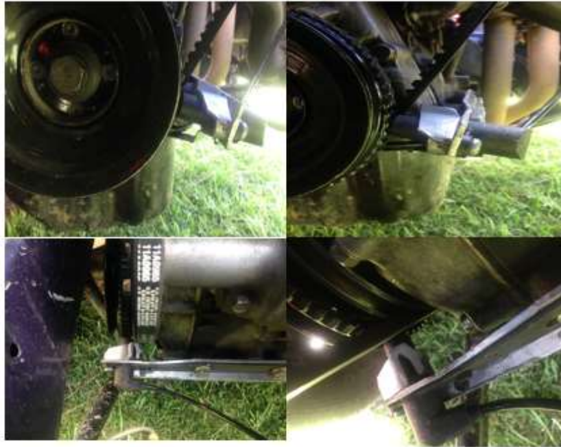
Ilustración 49 Fijación del Sensor CKP (el autor, 2016)
