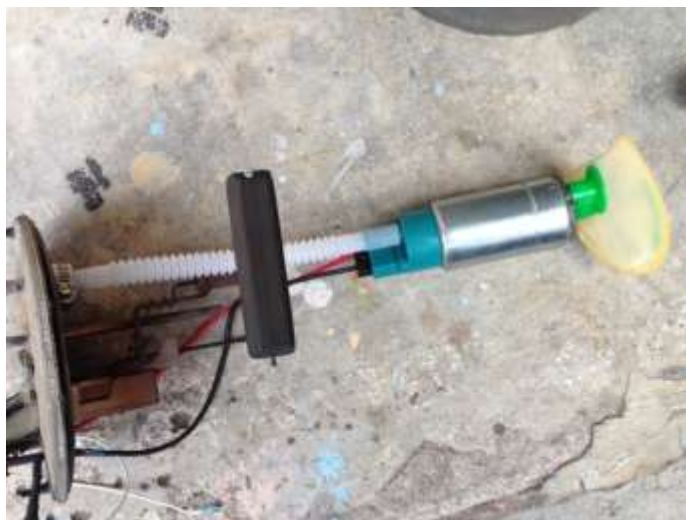
Ilustración 59 Instalación Bomba Eléctrica de Combustible (el autor, 2016)
