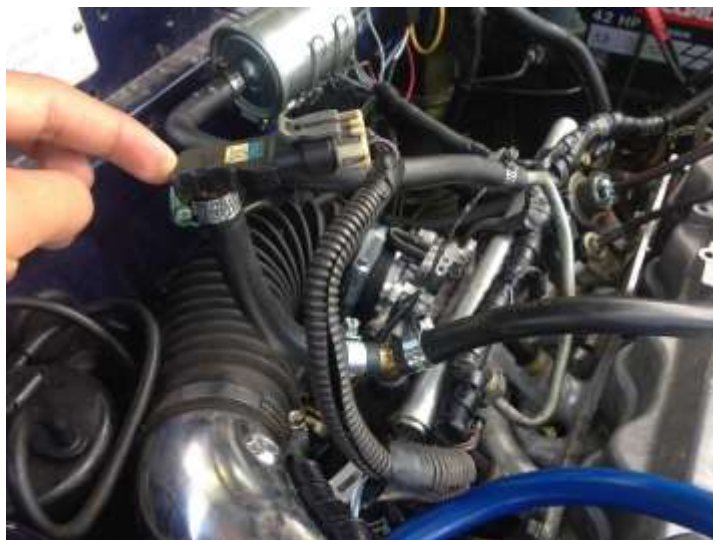
Ilustración 53 Ubicación Sensor MAP (el autor, 2016)
