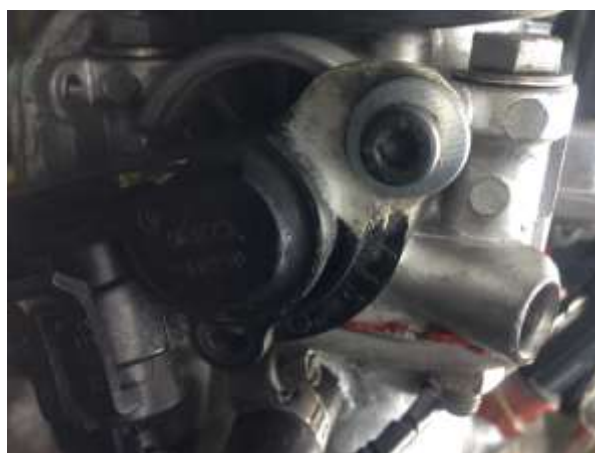
Ilustración 54 Ubicación Sensor TPS (el autor, 2016)
