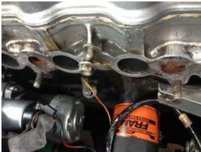
Ilustración 38 Vista Entrada de admisión del motor (el autor, 2016)
