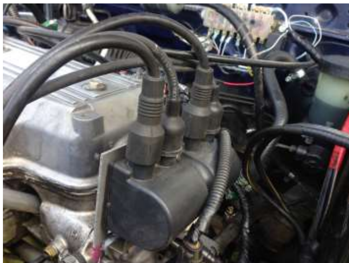
Ilustración 57 Ubicación Mono bobinas (el autor, 2016)
