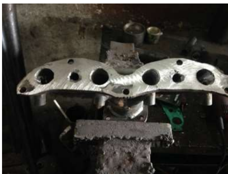
Ilustración 39 Fabricación Múltiple de Admisión (el autor, 2016)
