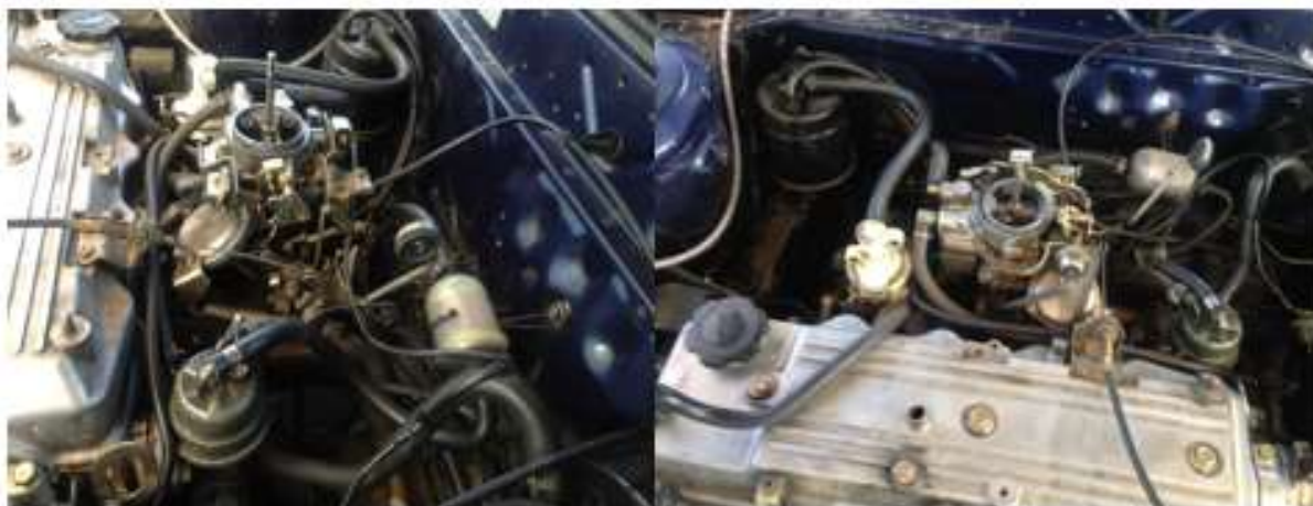
Ilustración 34 Desmontaje del Carburador y sus Cañerías (el autor, 2016)
