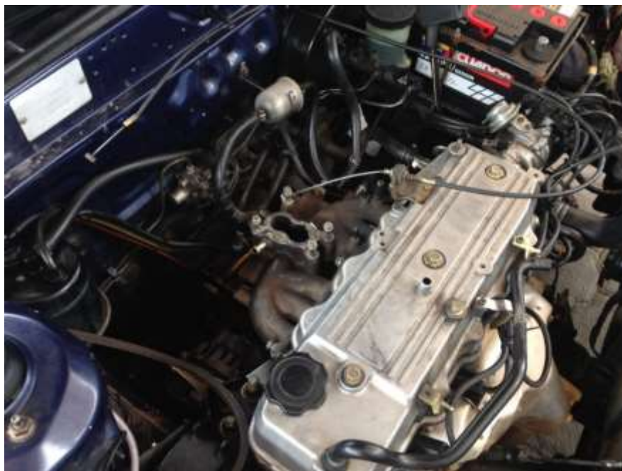
Ilustración 35 Toma del Múltiple de Admisión (el autor, 2016)
