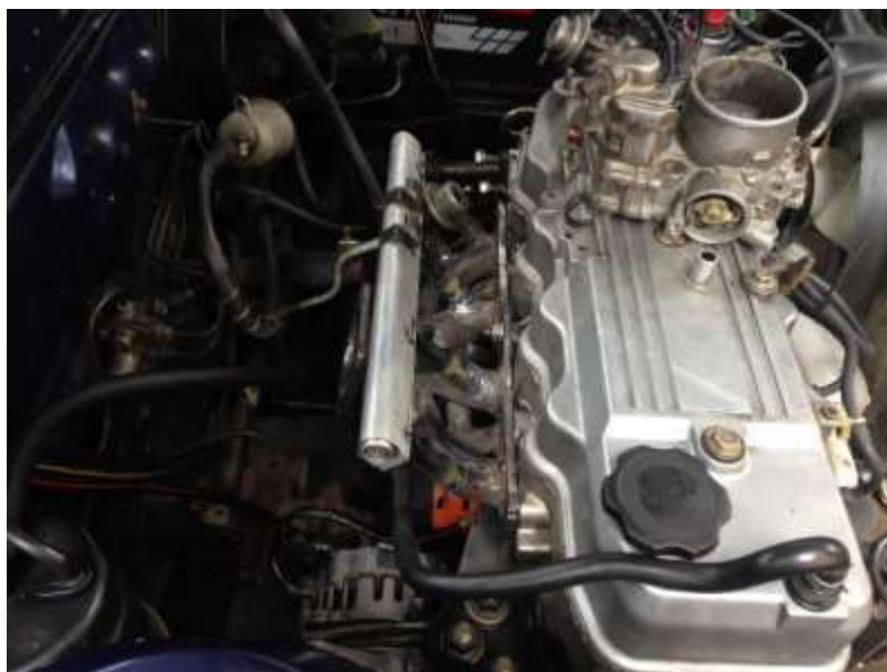
Ilustración 41 Montaje de riel de Inyectores (el autor, 2016)
