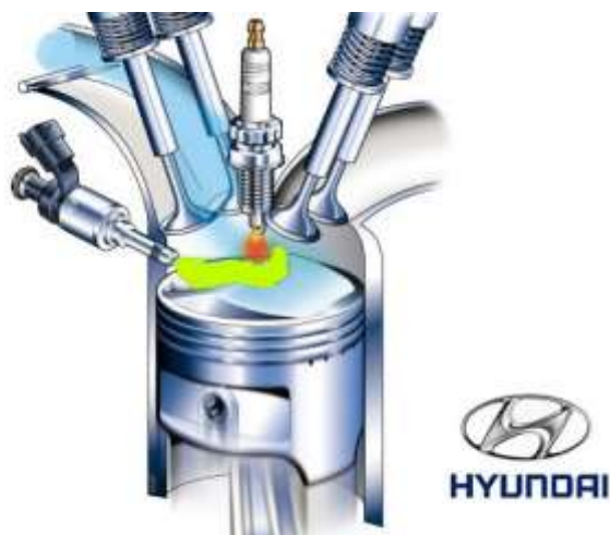
Ilustración 9 Inyección Directa de Combustible (Mobis, 2015)
