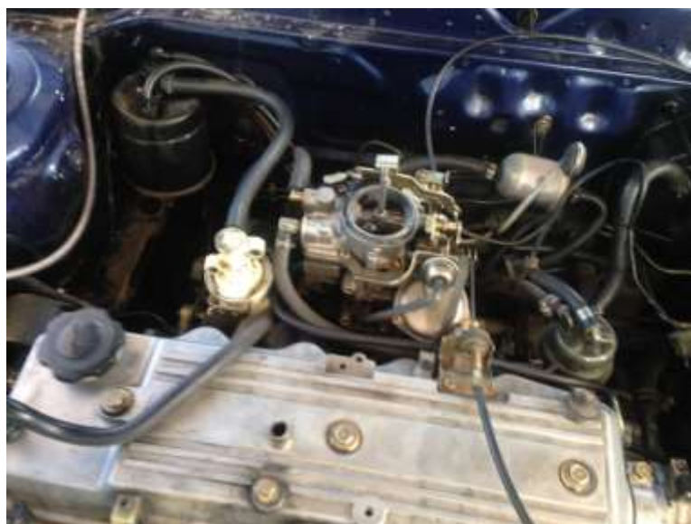
Ilustración 33 Desmontaje del Carburador (el autor, 2016)
