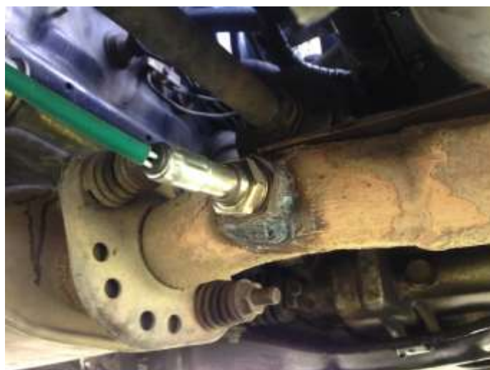
Ilustración 60 Ubicación Sensor de temperatura (el autor, 2016)
