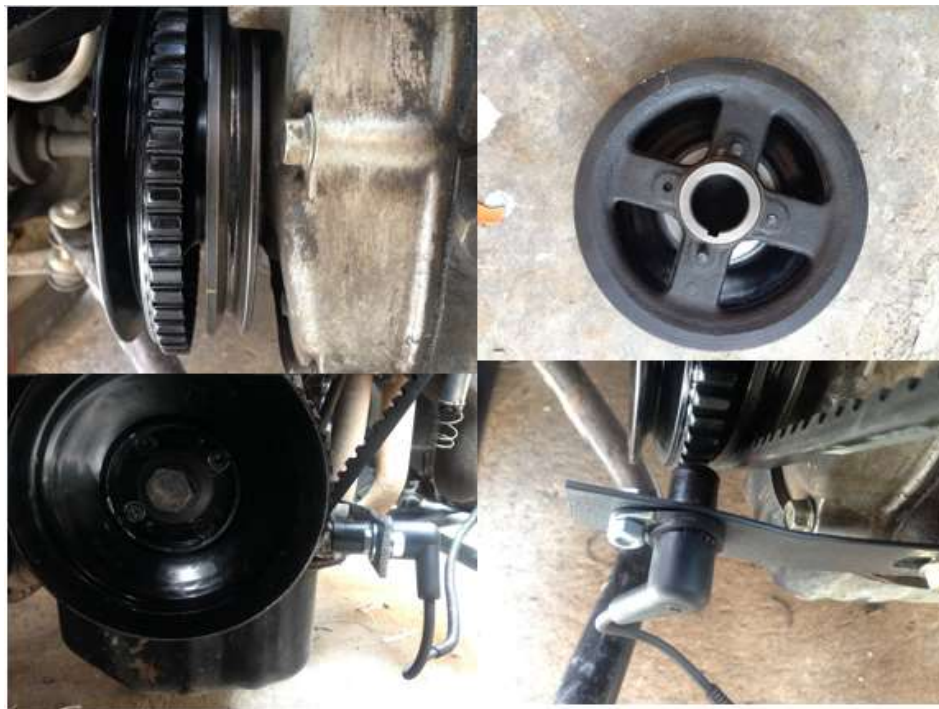
Ilustración 48 Modificación de la Polea del Cigüeñal (el autor, 2016)
