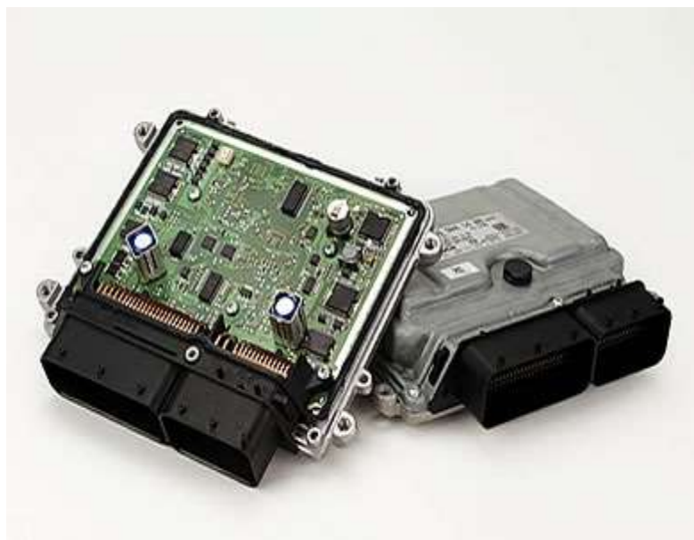
Ilustración 30 Unidad Electrónica de Control Constitución interna y externa (Continental - Automotive, 2013)
