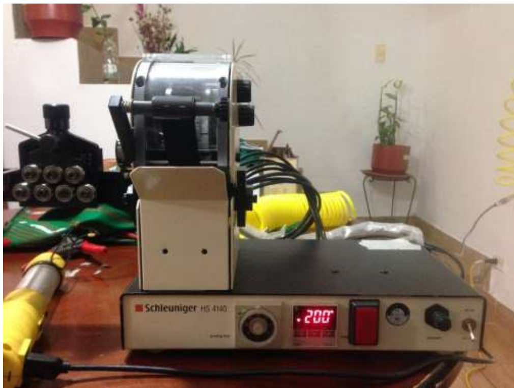
Ilustración 44Maquina Marcadora de Cables (el autor, 2016)
