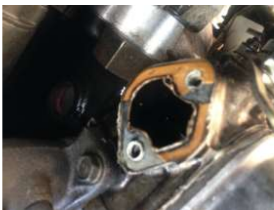
Ilustración 58 Orificio de la Bomba Mecánica de Combustible (el autor, 2016)
