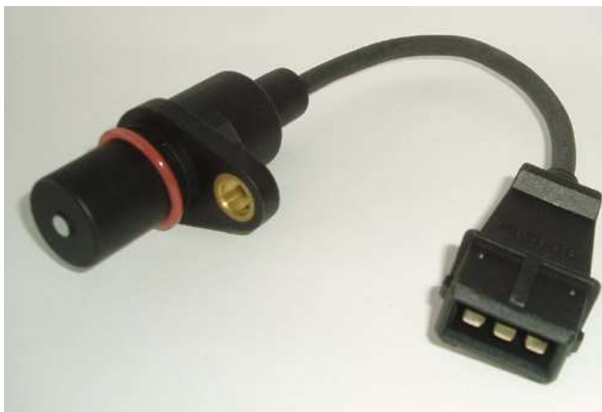
Ilustración 24 Sensor de Posición del Cigüeñal (Mercado Libre, 2015)
