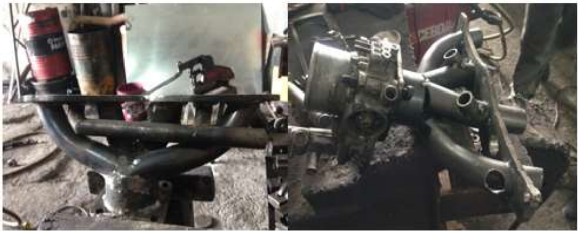
Ilustración 40 Soldadura de Múltiple de Admisión y Cañerías de Refrigeración (el autor, 2016)
