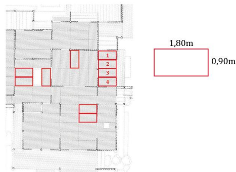
Figura 15. Esquema módulo Tatami Villa Imperial Katsura (Bettosini, 2015)
