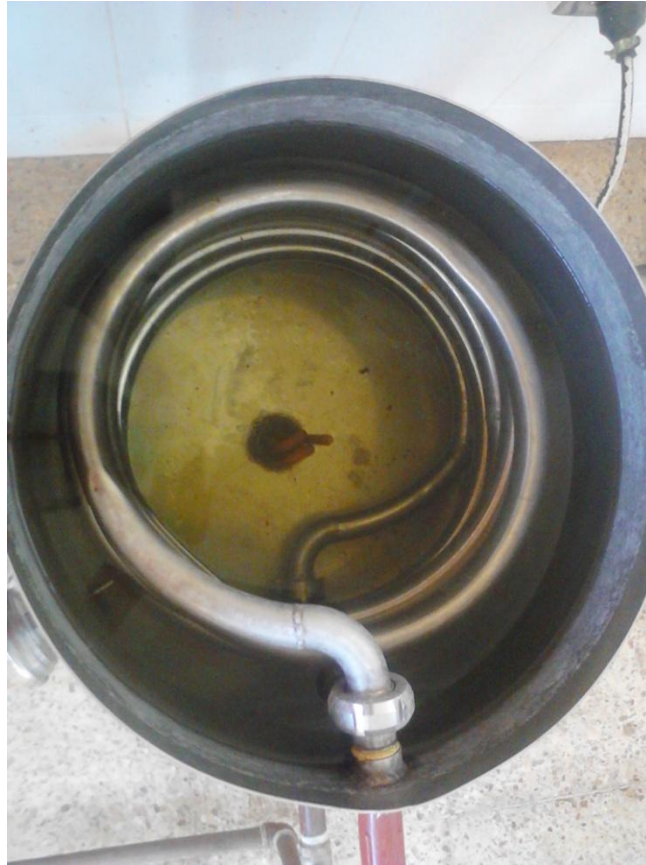
Figura 3.10. Intercambiador de calor con serpentín y resistencia
