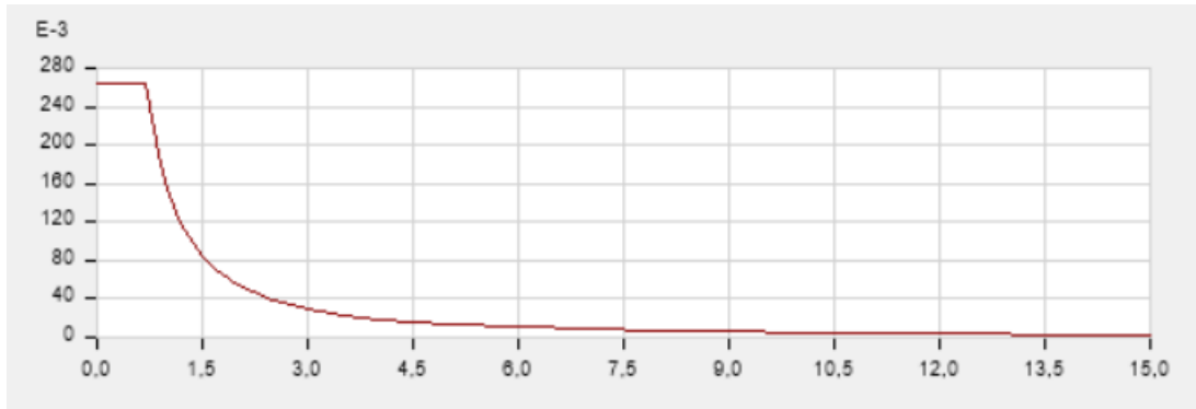
Figura 2: Espectro sísmico elástico de diseño ( S_a - T )
