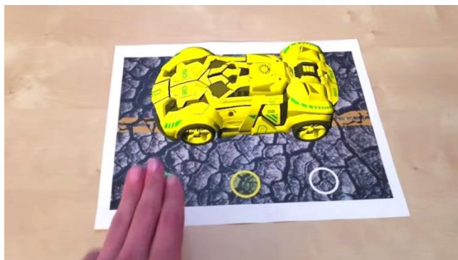
Fig. 7 – Vuforia, Botones Virtuales que cambian de color el modelo 3D
