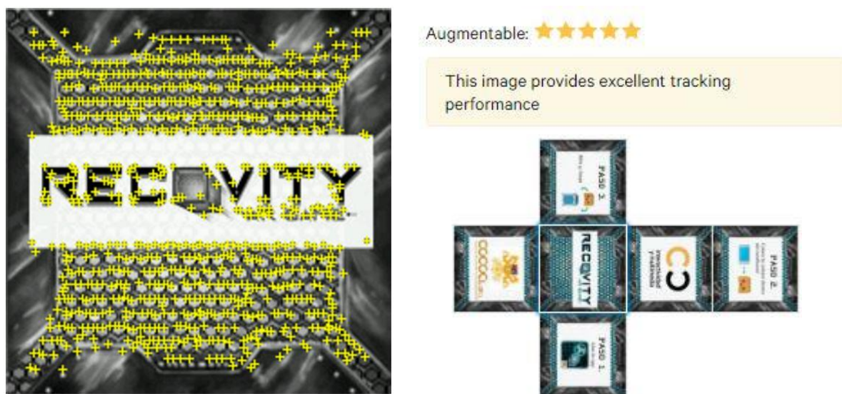
Fig. 5 - Marcadore con sus puntos de detección calculados por el algoritmo de Vuforia.
