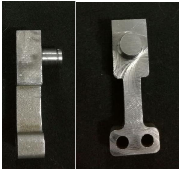
Figura 55. Seguidor vertical terminado
