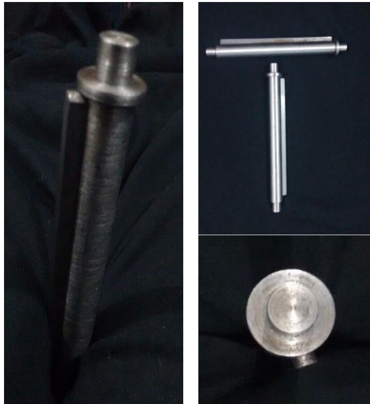
Figura 52. Eje central terminado
