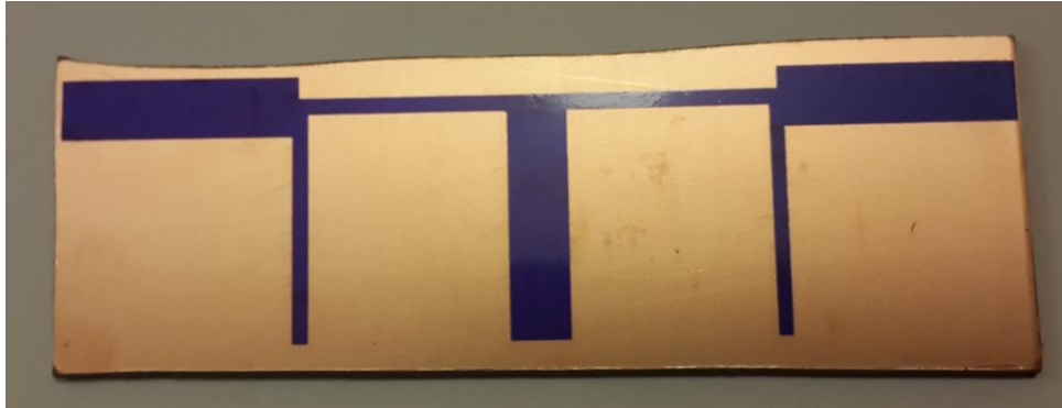
Figura 33. Lámina de cobre con el patrón del circuito en la película foto-resistiva.
