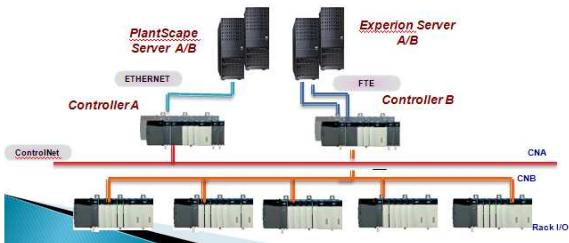
Gráfico 32: Arquitectura en el paso 9 de la migración a Experion R311.2
