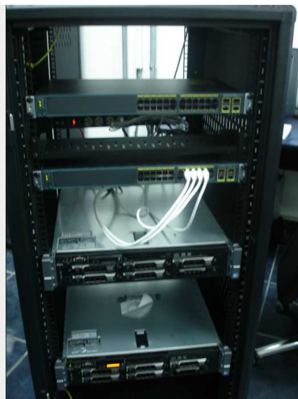
Gráfico 19: Parte superior switches para red FTE y en la parte inferior los dos servidores con el nuevo sistema Experion R311.2
