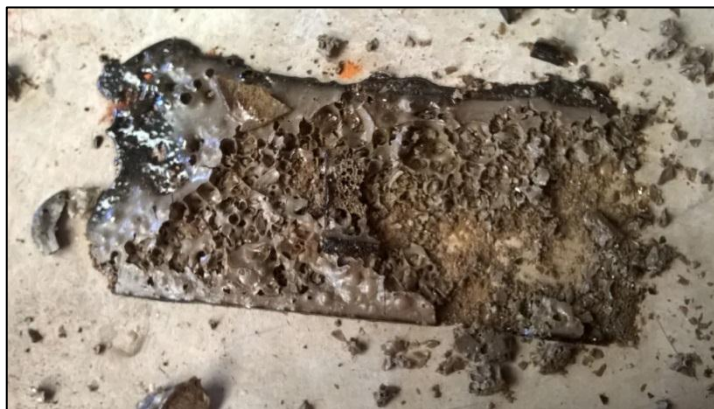
Figura 13 Probeta obtenida de la fundición de los desechos plásticos
