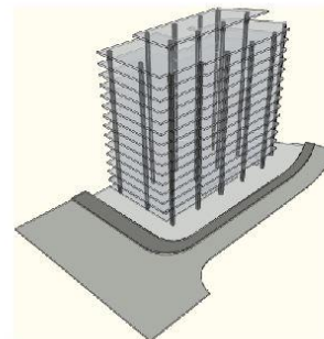
LOSAS Y VOLADOS CON ESTRUCTURA MIXTA (HORMIGÓN + METAL)
