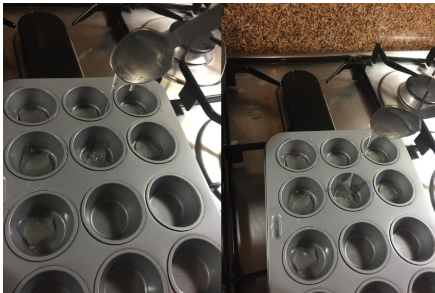
Figura 5. Primera fase del polímero: El resultado es una masa oleaginoso, pungente y que no tomo la forma deseada. Después de dos días no se endureció.
