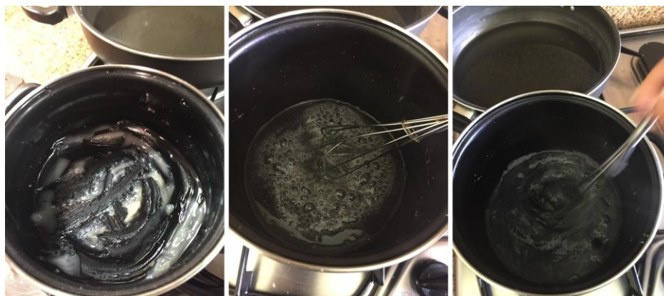
Figura 2. Primera fase del polímero, nótese que se ve líquido y brillante.
