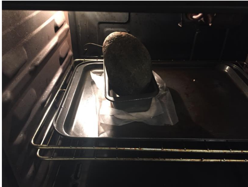
Figura 8. Tercera fase del polímero: La presión de la piedra fue distribuída de manera puntual sobre el polímero, el cual permitió que el material se expanda y forme poros de aire.
