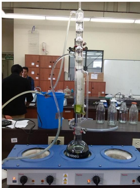
Figura 6. Equipo de Extracción Soxhlet.
