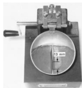
Figura B : Muestra después que la ranura se ha cerrado. Fuente: ASTM D-4318.
