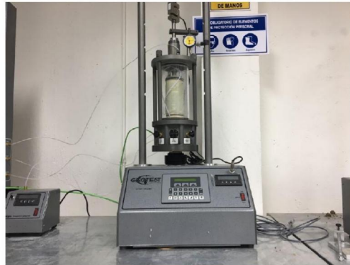
Figura Configuración de la ubicación de la celda en el marco de carga del Triaxial.
