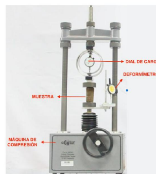
Figura B.7: Configuración del ensayo de compresión simple sin confinamiento.
