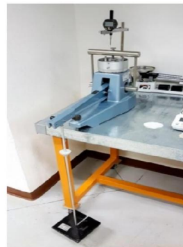
Figura L: Configuración del equipo para el ensayo de Consolidación.
