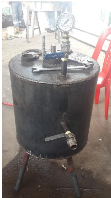
Figura 20: Construcción de máquina para pruebas de preno estopa
