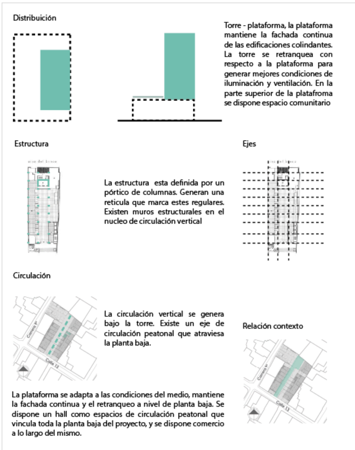
Figura 3. Análisis Banco. Planos obtenidos de http://issuu.com/edisonhena06/docs/torre_plataforma
