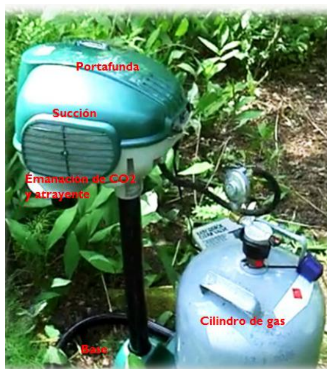
Figura No. 8: Trampa Mosquito Magnet y sus componentes. Fuente: (Antero, 2012).
