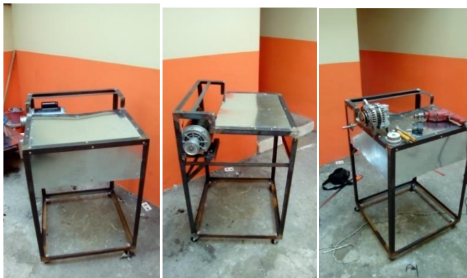
Figura 32 Estructura con cubiertas de tol
