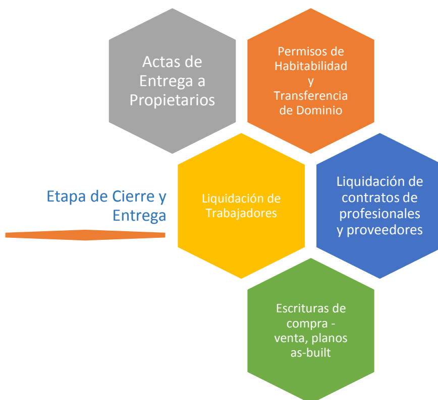
Ilustración 59. Elementos Legales a Desarrollarse en la Etapa de Entrega y Cierre del Proyecto.
