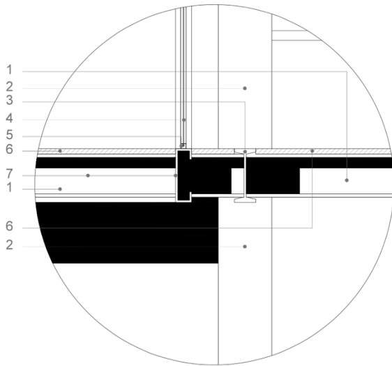
Figura 48. Detalle de unión viga-columna. Elaboración propia.
