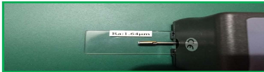
Figura N. 1. Verificación de la Rugosidad (Ra) con Patrón del Equipo
