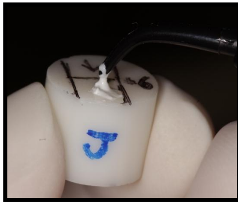
Figura 31: Colocación de pasta diamantada en muestra pulida con sistema "Jota", (Diamond Polish de 1.0 \mu\text{m} (Ultradent Products Inc. UT, USA)
