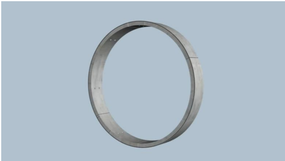
Figura 20 Anillo de dovelas (TBM/Tunneling Video, 2011)
