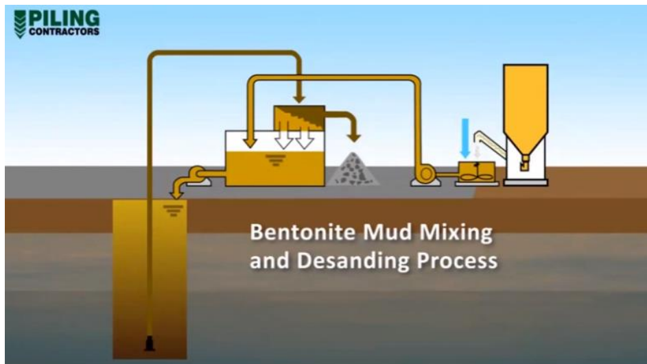
Figura 9 Uso de Bentonita para excavación (Diaphragm Wall Construction Methodology, 2014)
