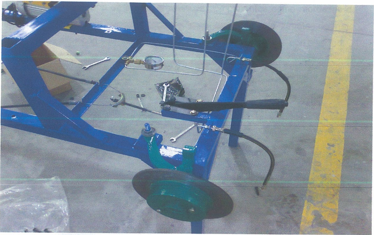
FIGURA 4.9 : Chasis, manguetas y discos de freno con pintura mejorada y diferenciada en cada uno.
