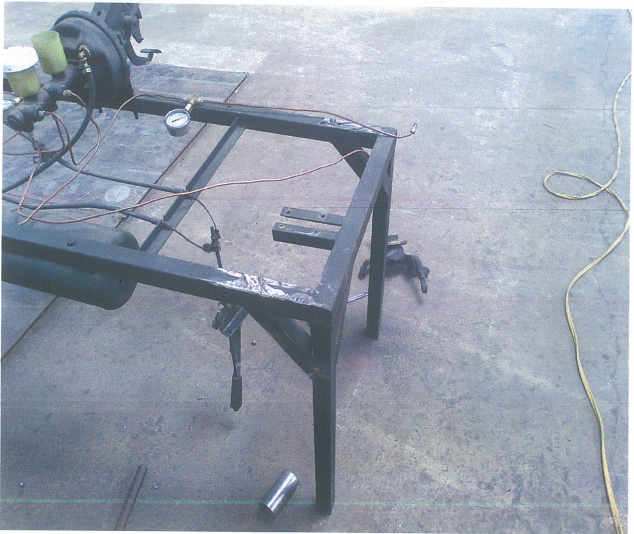
FIGURA 4.2 : Instalación de las tuberías de cobre, manómetros de presión junto con la bomba principal de freno con medidas.
