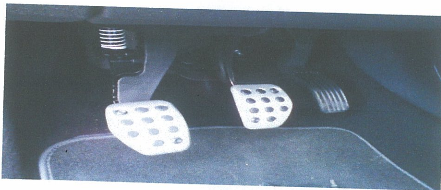
Fig 2.1: Pedal de freno situado en la mitad del pedal del embrague (izquierda) y del pedal acelerador (derecha).
