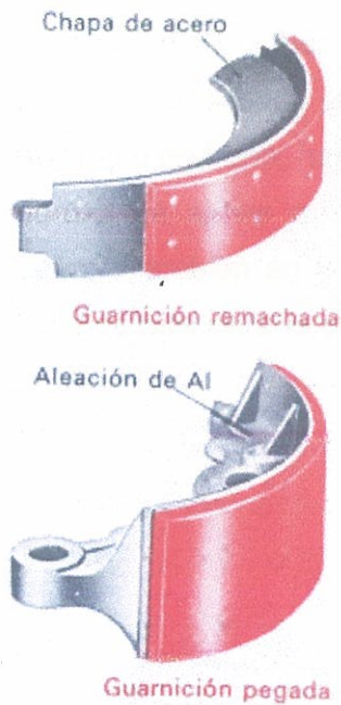
Fig 2.13: Guarniciones de las zapatas de freno, pueden ser pegadas o remachadas.
