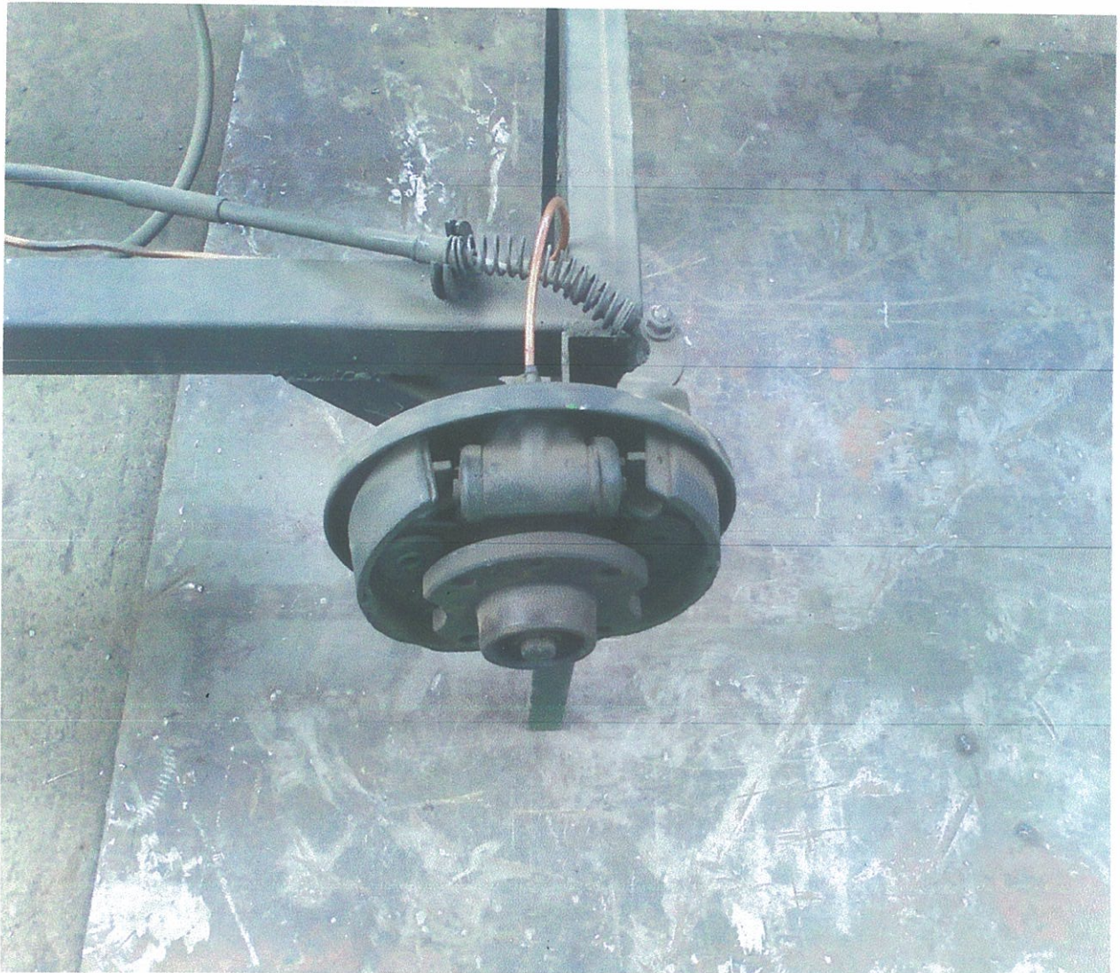
FIGURA 4.3 : Soporte tambor de freno, cilindro de la rueda y el par de zapatas de accionamiento simple. La cañería está instalada.
