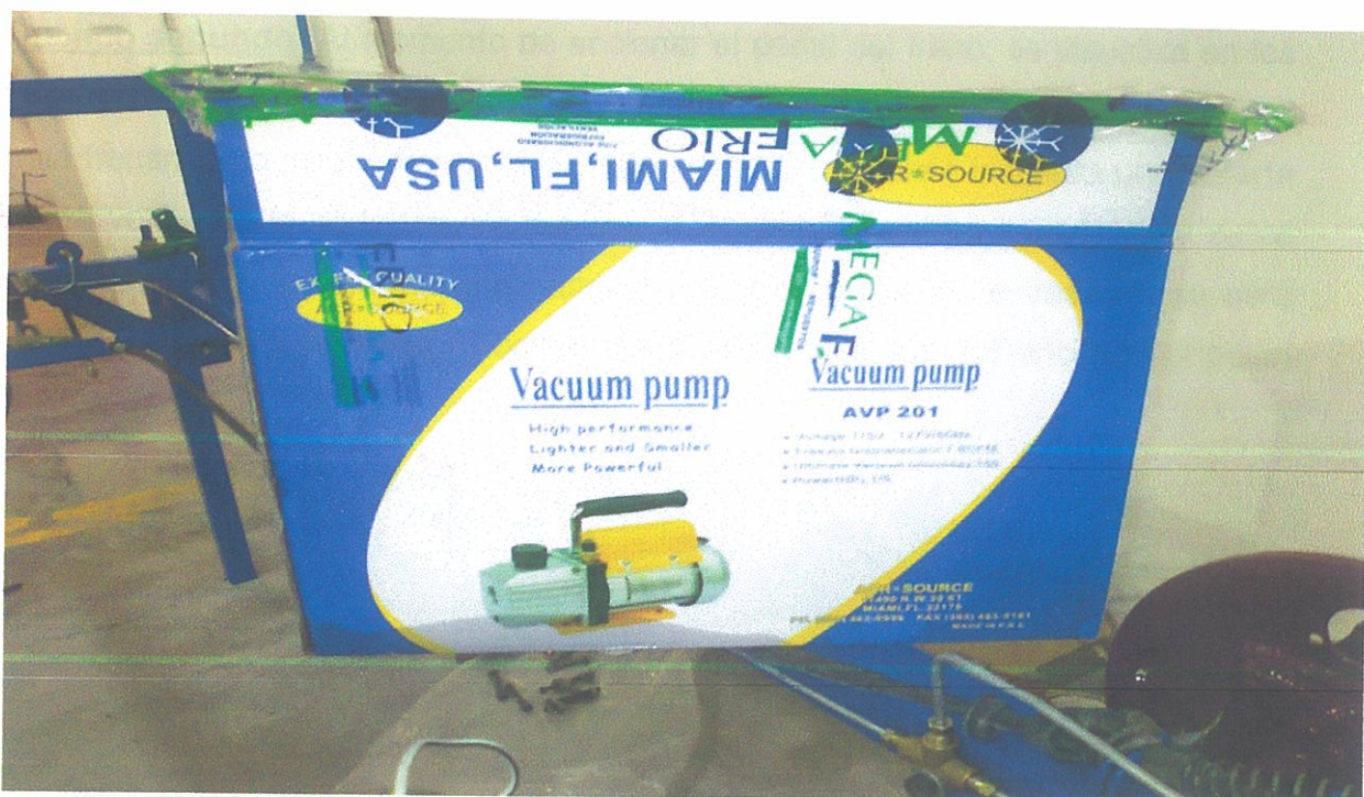
FIGURA 4.12: Bomba de vacío de 110 V ~AC, de 1/5 de HP.
