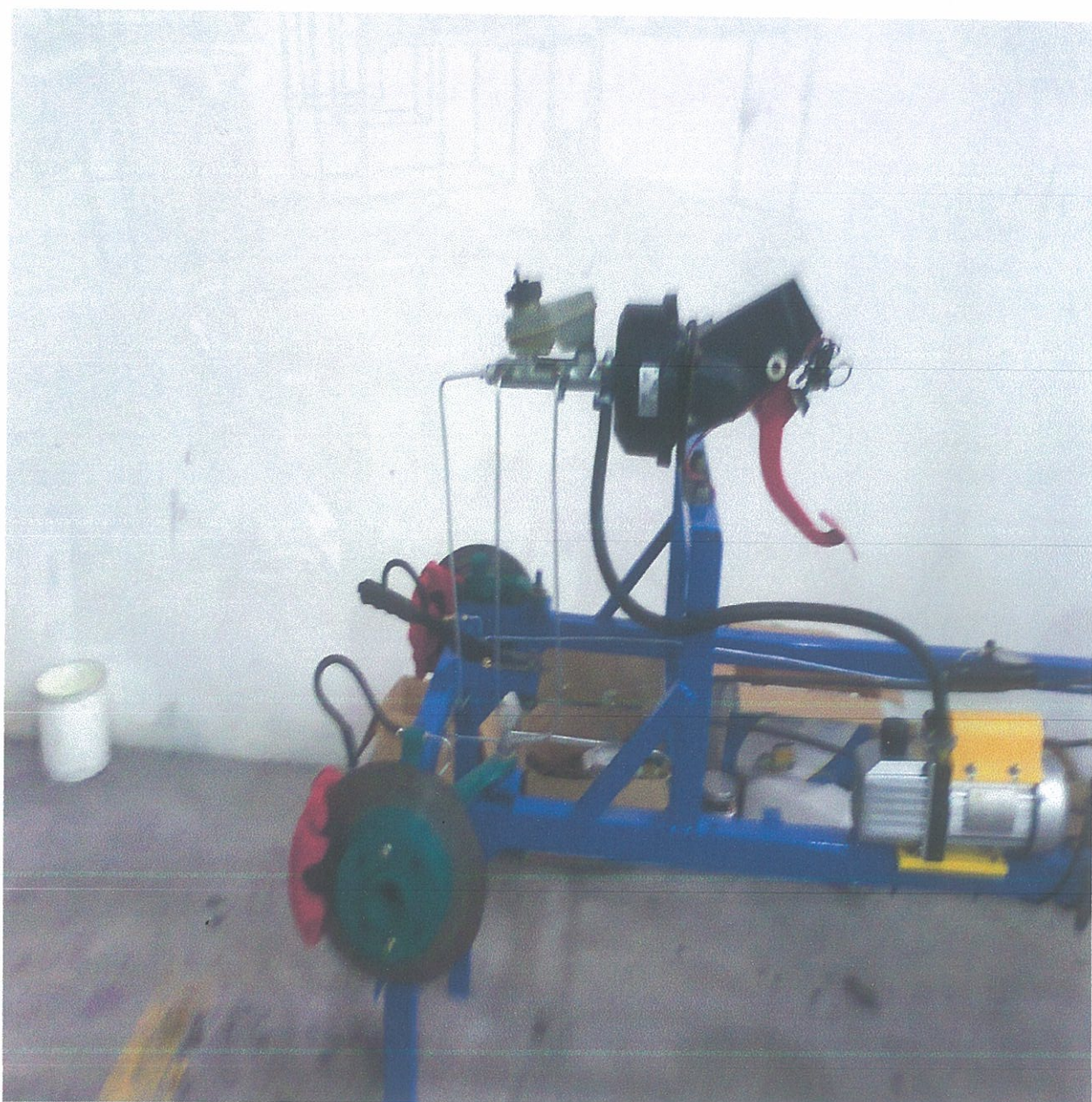
FIGURA 4.16: Deposito del liquido de frenos montado en el cilindro maestro el cual será llenado con fluido DOT 3. Bomba de vacío de color amarillo conectada mediante una manguera al servofreno para la multiplicación de la fuerza al momento de accionar el pedal del freno.
