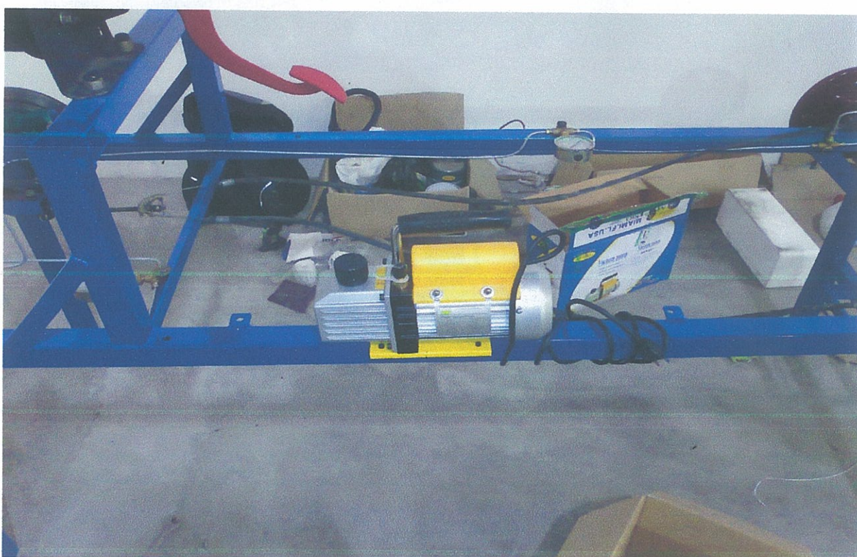
FIGURA 4.13: Bomba de vacío instalada y fijada en el chasis del sistema hidráulico de frenos.
