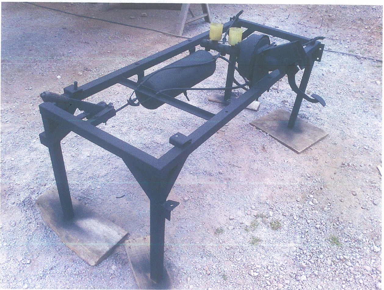
FIGURA 4.1 : Soporte metálico o chasis, con freno de mano, tanque de presión y servofreno instalado.
