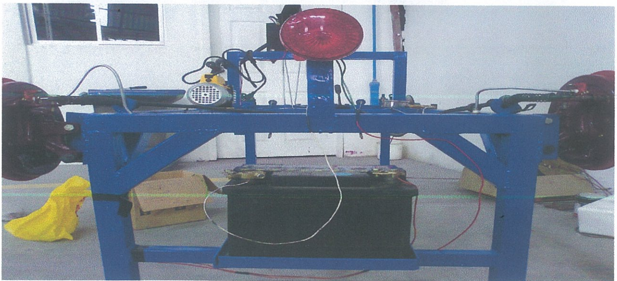
FIGURA 4.14: Representación del testigo luminoso conocido como luz de stop y la batería de 12 voltios instalada en la carrocería del sistema de frenos.
