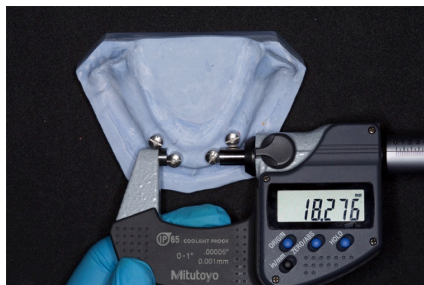
Imagen 18. Medición de la distancia en los modelos de muestra utilizando un micrómetro digital de alta precisión.
