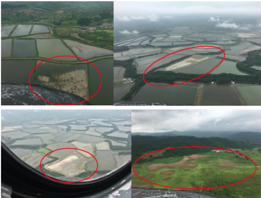
Figura 72. Licuefacción en el litoral del Ecuador producto del terremoto Muisne - Pedernales (GEER, 2016)
