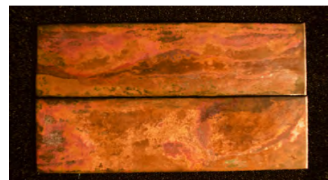
Figura 10. Detalle de placas después de impresión y limpiado con aguarrás, vinagre y sal y lavado con agua.
