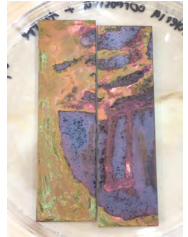
Figura 15. Placa después de limpieza con vinagre y sal y posteriormente con agua.
