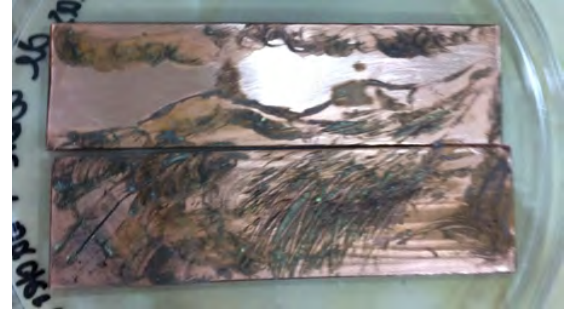
Figura 4. Placas trabajadas con la mezcla de azufre y bacteria (pasta).
