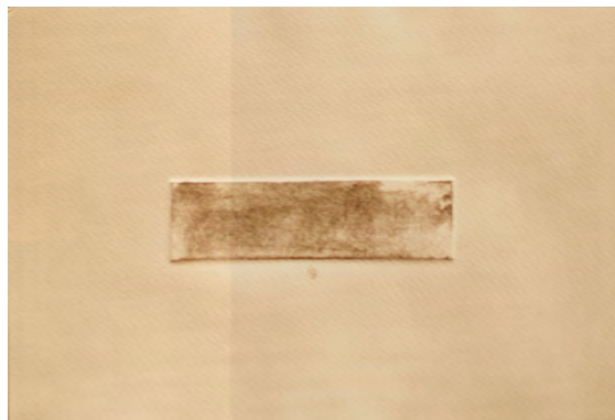
Figura 14. Segunda impresión de la placa limpiada con limón y sal. Se puede observar que la imagen desaparece al retirar la capa de corrosión encima de la placa. Desaparece el grabado falso.
