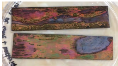
Figura 9. Resultado después de lavado con agua, limpiado con alcohol y limpiado con vinagre.
