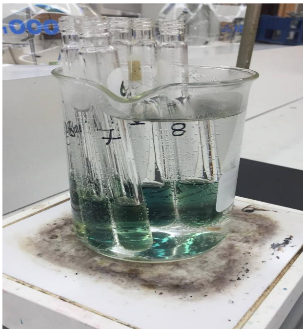
Fotografía 2: Muestras en baño María para acelerar la reacción en la determinación por el método de Antrona.
