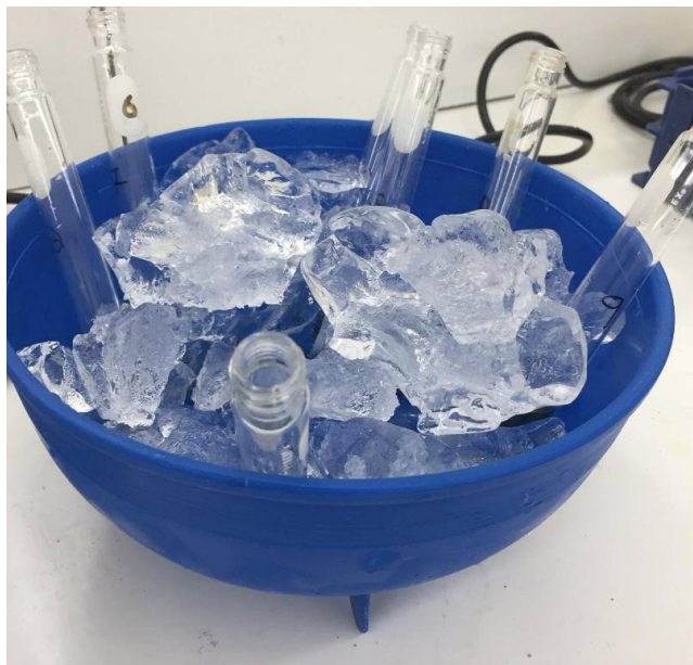
Fotografía 3: Muestras en baño de hielo a 0°C para acelerar la reacción en la determinación por el método de Antrona.
