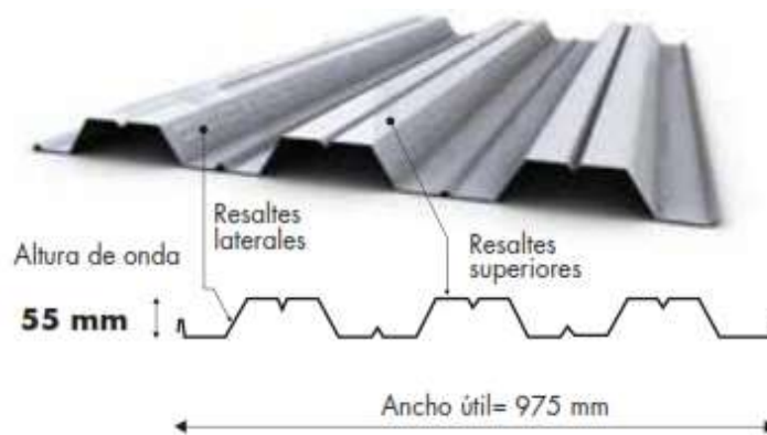
Figura 8: Especificaciones geométricas losa colaborante.
