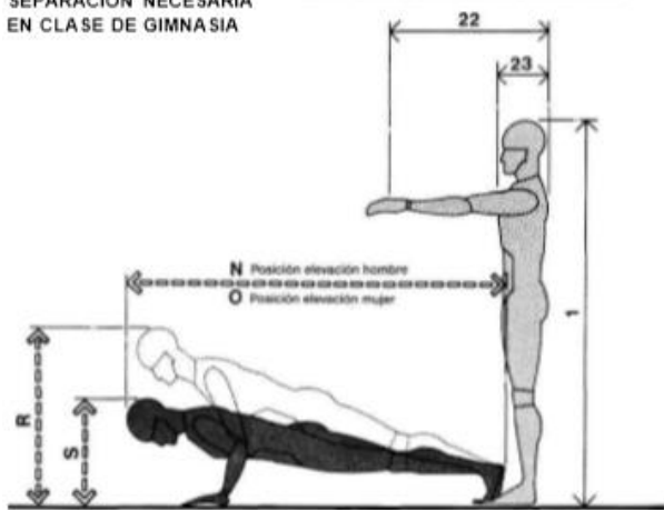
REQUISITOS DE ESPACIO PARA POSICIONES DE ELEVACIÓN
