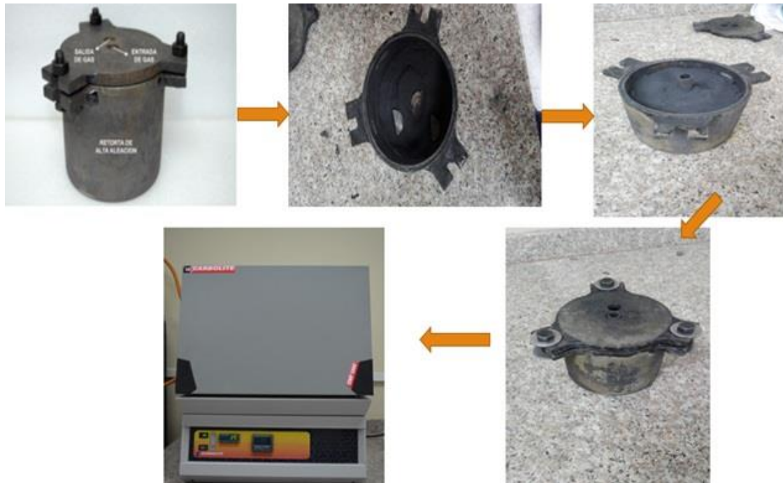
Figura. 10. Procedimiento boronizado por empaquetamiento
