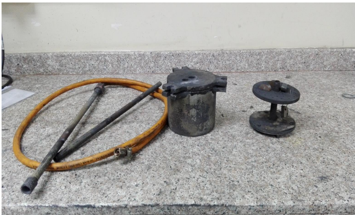
Figura. 17. Contenedor de lecho fluidizado
