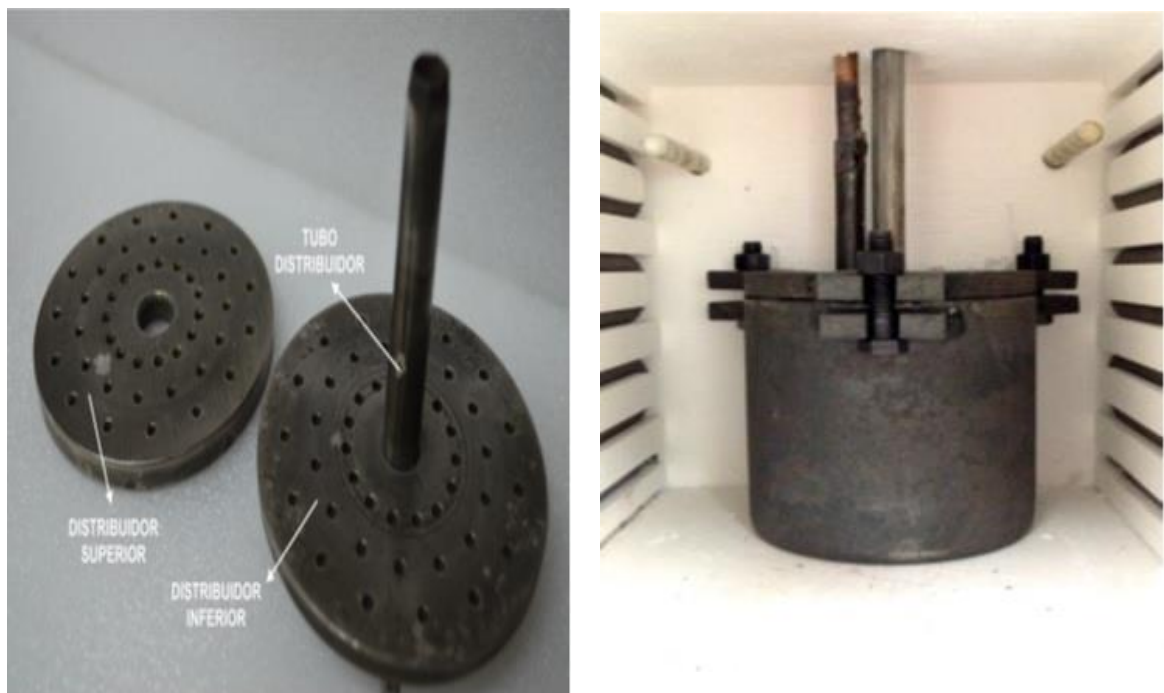
Figura. 14. Esquema retorta para boronizado por lecho fluidizado (Carrillo, 2015)
