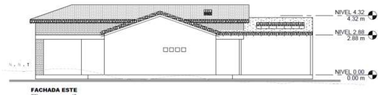
Ilustración 162 Fachada Este Casa 20 A
