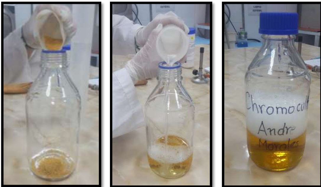
Figura 29. Disolución de reactivo de identificación chromocult con el agua destilada en un recipiente de vidrio Fuente: Andrea Morales
