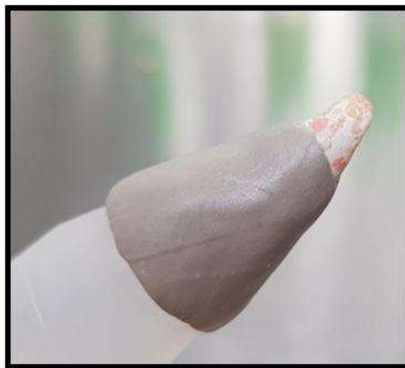
Figura 40. Colocación de resina epóxica en la zona de interfase de la muestra y el tubo falcón Fuente: Andrea Morales
