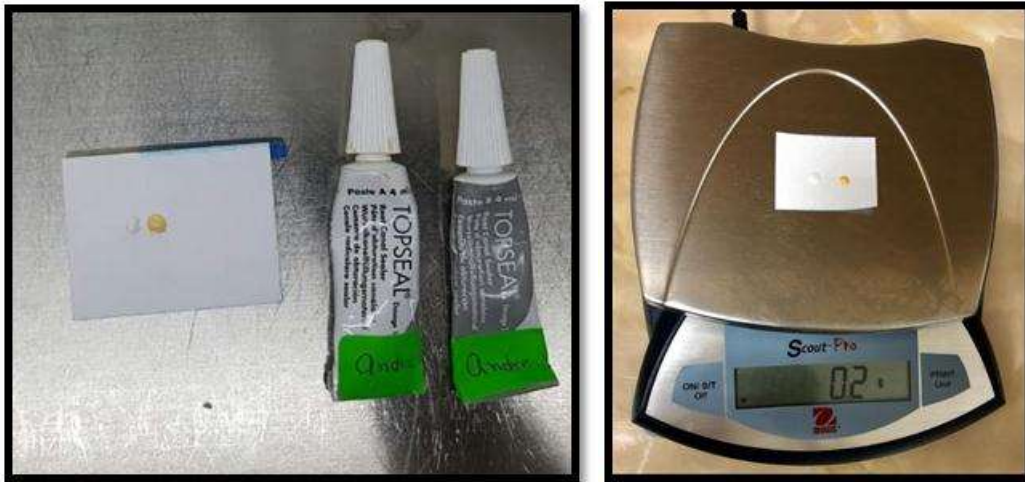
Figura 17-18. Estandarización del cemento sellador topseal en balanza analítica
