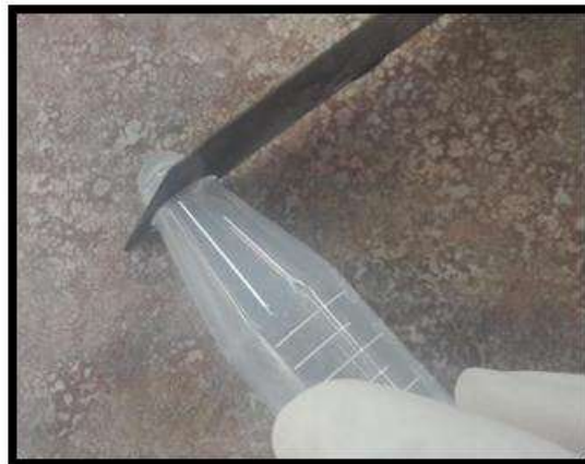
Figura 34. Ensamblaje de la muestra al tubo falcón Fuente: Andrea Morales
