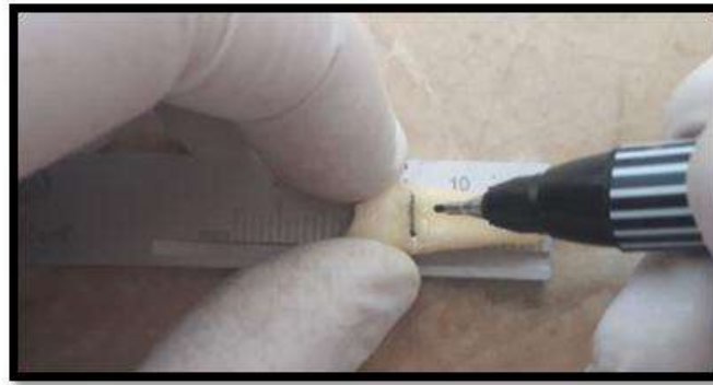
Figura 2. Señalización con marcador permanente para estandarizar la muestra Fuente: Andrea Morales
