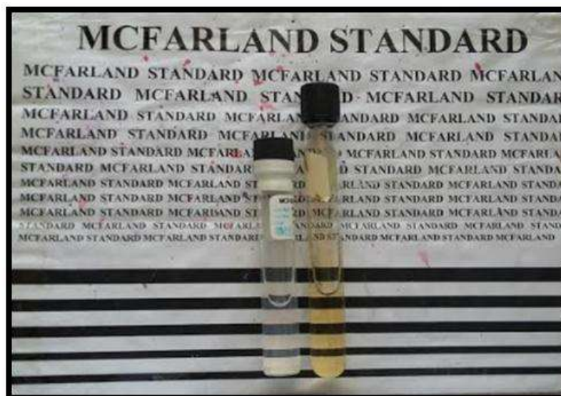
Figura 42. Estandarización de colonias de Enterococcus Faecalis mediante método standart mcfarland Fuente: Andrea Morales
