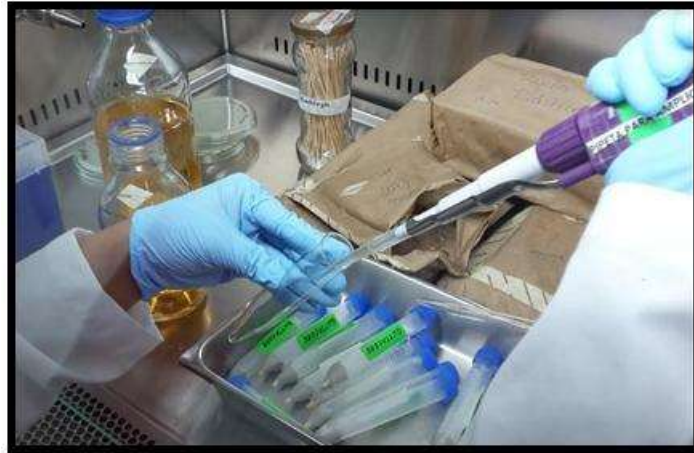
Figura 47. Colocación de Chromocult en el interior del tubo de ensayo de vidrio Fuente: Andrea Morales
