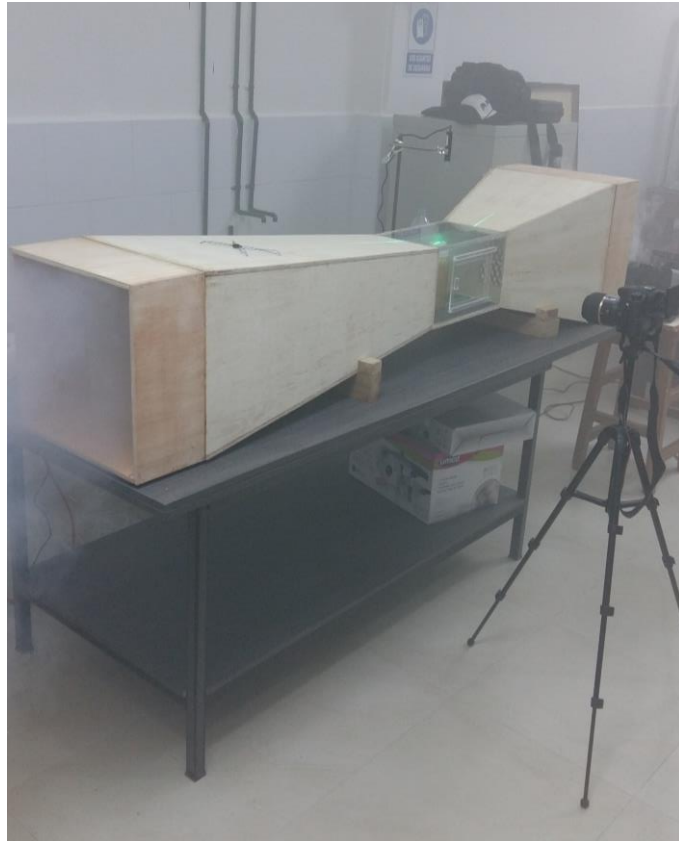
Figura 7: Sistema PIV de Bajo Costo Implementado
