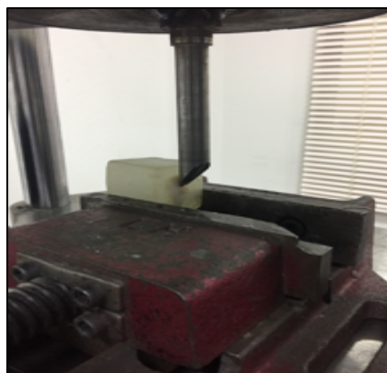
Figura 43. Aplicación de la fuerza sobre la resina.
