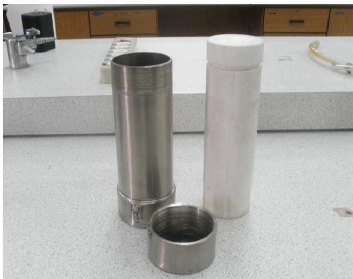
Figura 3.14 Reactor de teflón para tratamiento hidrotermal
