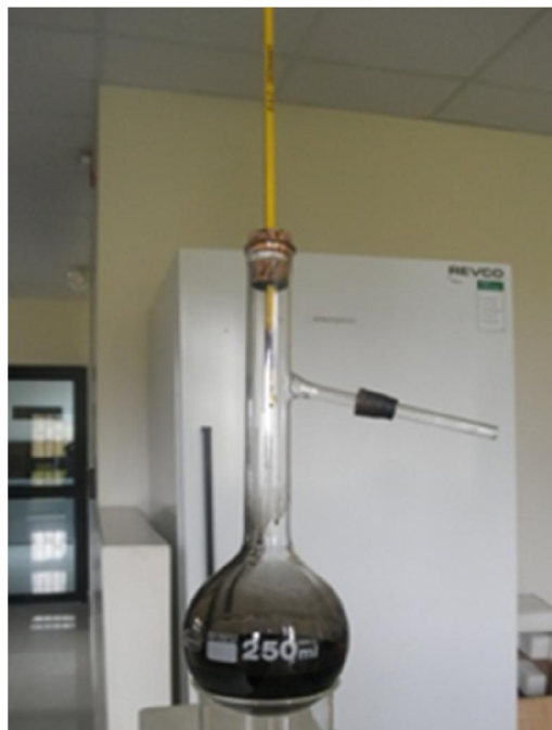
Figura 3.15 Reactor intermitente con aceite lubricante usado
