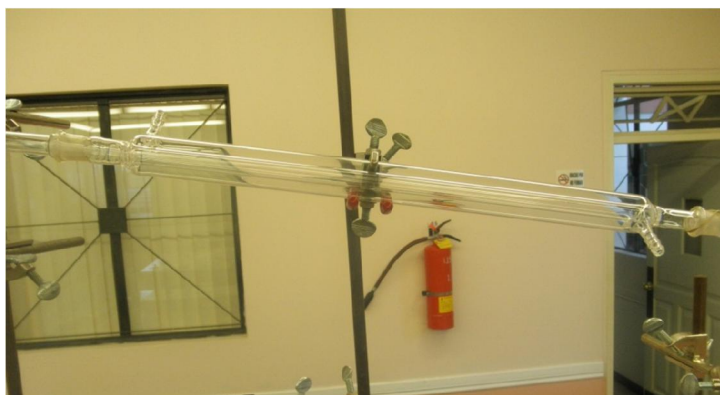
Figura 5.9 Condensador de producto craqueado
