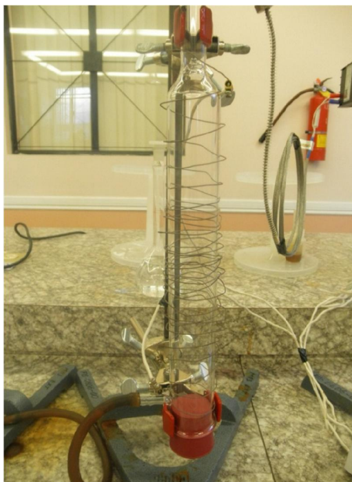
Figura 5.5 Sección de calentamiento con niquelina enrollada
