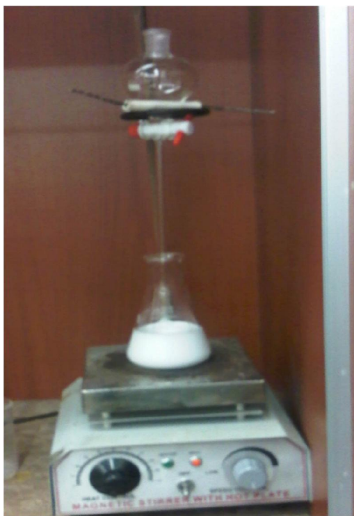
Figura 3.13 Adición de TEOS con embudo de separación para sintetizar aluminosilicatos
