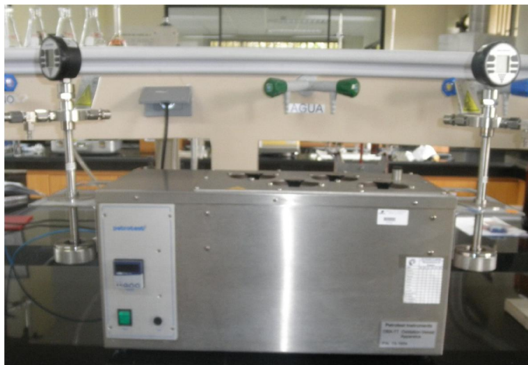
Figura 3.5 Equipo de calentamiento para ensayo corrosión a la lámina de cobre Petrotest Instruments
