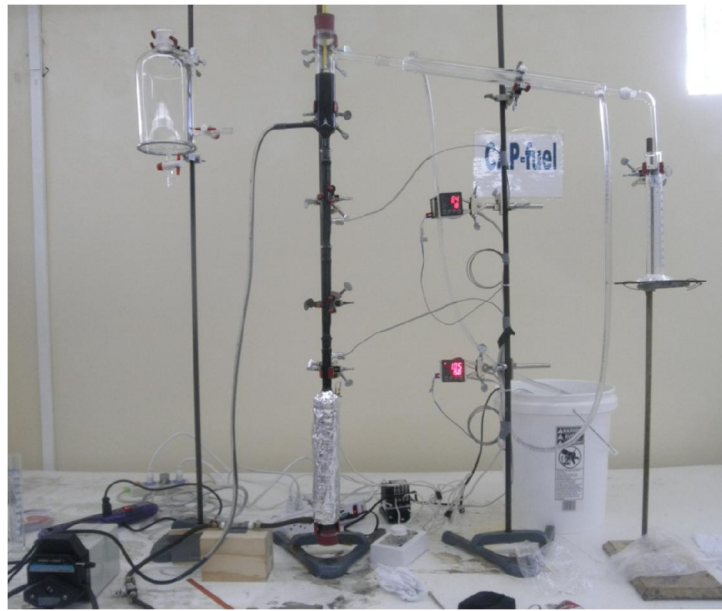
Figura 5.13 Reactor de lecho fijo de flujo ascendente con aceite lubricante usado
