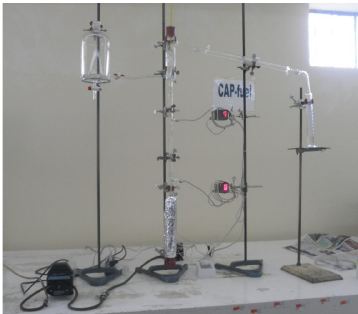
Figura 5.11 Reactor de lecho fijo armado en el Laboratorio de Desarrollo de Energías Alternativas
