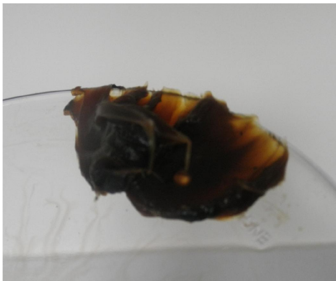
Figura 6.4 Subproducto del craqueo térmico del polietileno de baja densidad
