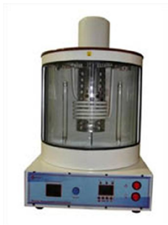
Figura 3.2 Baño térmico para viscosidad cinemática, modelo: Q303SR
