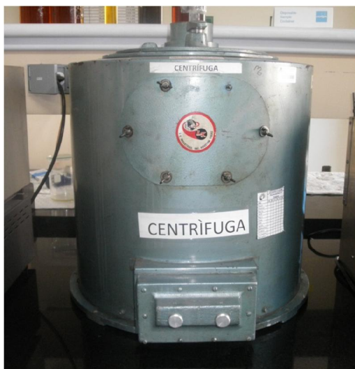
Figura 3.4 Centrifuga de líquido L-K industries 699C
