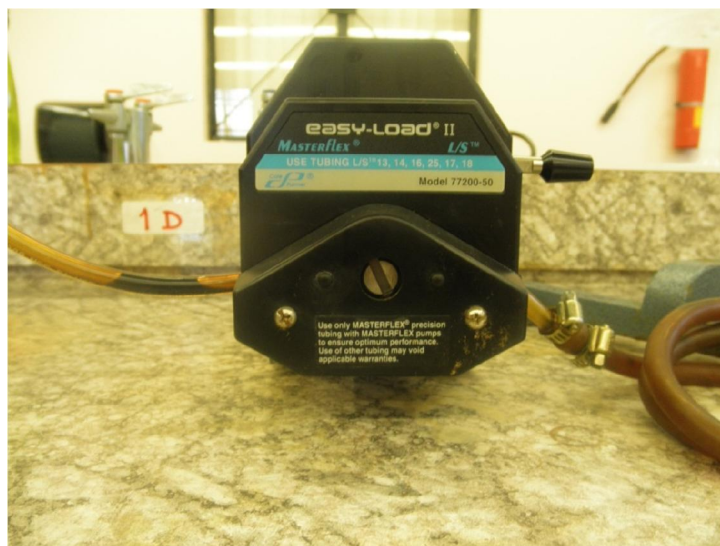
Figura 5.3 Bomba peristáltica MASTERFLEX para alimentación de material prima
