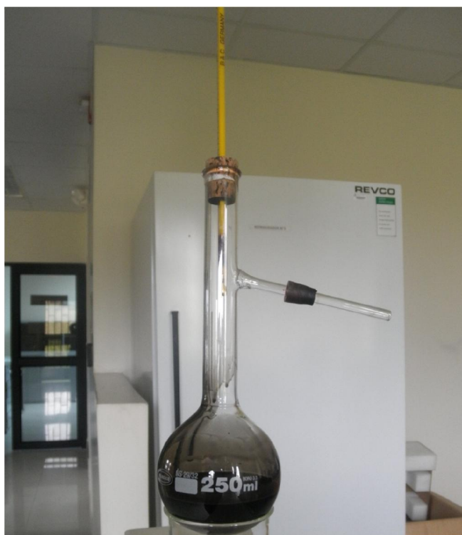
Figura 4.5 Reactor intermitente con aceite lubricante usado
