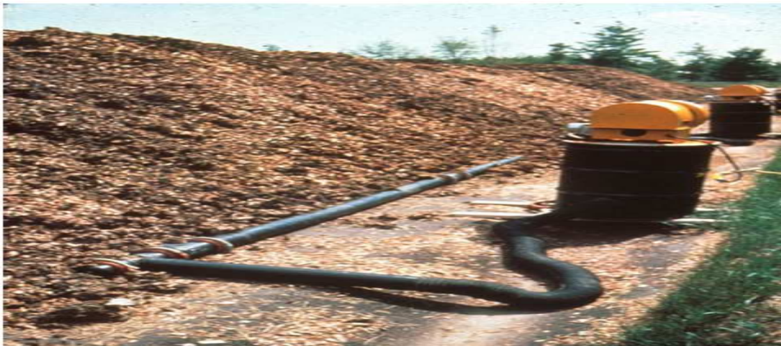
Gráfico 2: Pilas estáticas con aireación forzada (Haug, P. 1993).
